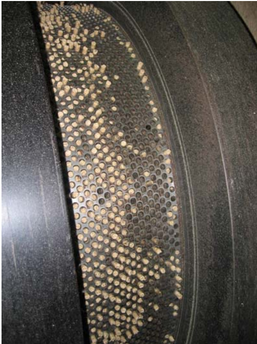
Joonis 3.58. Silindrilise matriitspressi matriits, P.Muiste foto
