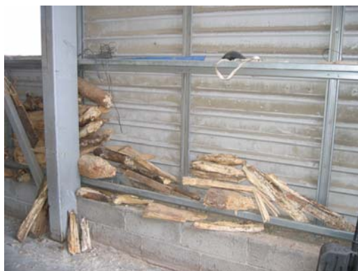
Joonis 8.36. Näidised kütusest eemaldatud lisanditest ja purustamata puutükkidest, foto Ü.Kask
