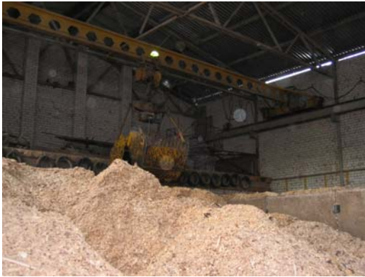
Joonis 8.18. Kütuse edastamine greiferiga Aardla katlamaja kütuselaos, foto Ü.Kask
