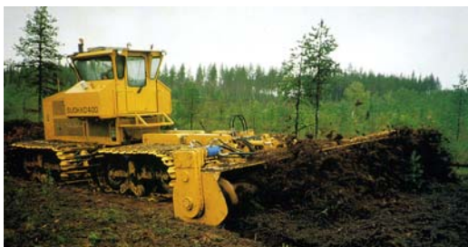
Joonis 3.64. Taimestiku eemaldamine ja raba pinna tasandamine seadmega RT-6.0H Soome firmalt SUOKONE OY
