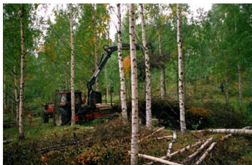
Joonis 3.4. Tüveste lõikamine ja kogumine harvendusraiel, P.Muiste fotod
