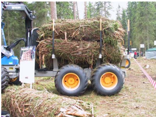
Joonis 3.48. Pakitud raiejäätmete transportiks saab kasutada ka tavalist metsaveo haagist, P.Muiste foto
