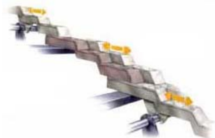
Joonis 4.5. Malekorras liigutatavate restielementidega kolle TRF, Rootsi firma KMW ENERGI AB
