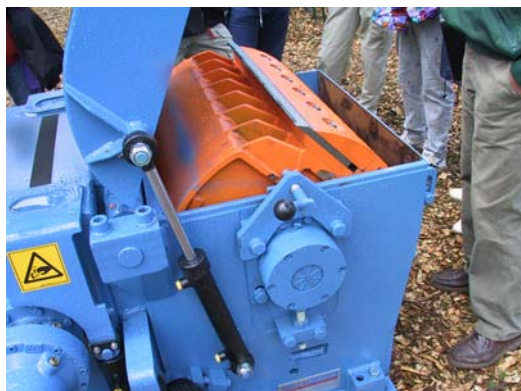
Joonis 3.29. Trummelhakkuri tööorgan, P.Muiste foto
