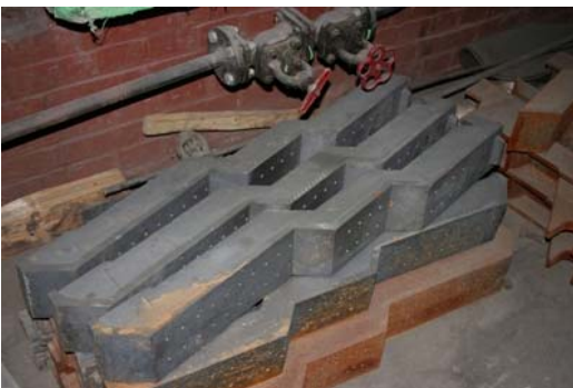
Joonis 8.13. Tartu tehase uued restilülid, foto Ü.Kask
