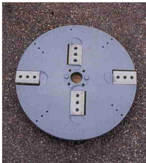
Joonis 3.27. Ketashakkuri tööorgan, P.Muiste foto
