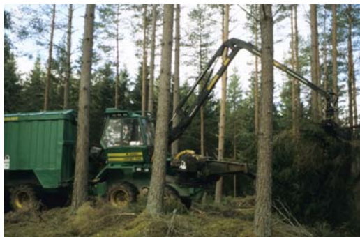
Joonis 3.11. Raiejäätmete kogumine ja hakkimine mobiilse hakkuriga Chipset 536C, P.Muiste foto
