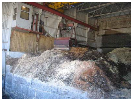
Joonis 8.33. Greiferiga ja mehitatud sildkraana, foto Ü.Kask
