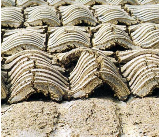
Joonis 3.67. Laineliselt pressitud tükkurvas, mis tagab minimaalse kontakti raba pinnaga ja kuivab seetõttu kiiremini
