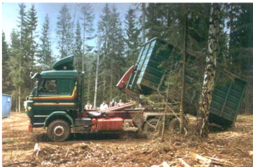
Joonis 3.13. Täidetud konteineri tõstmine veokile, P.Muiste foto
