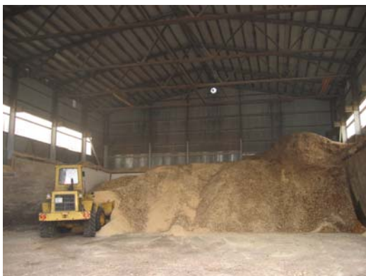
Joonis 8.29. Kütuse teisaldamine Männimäe katlamaja kütuselaos, foto Ü.Kask
