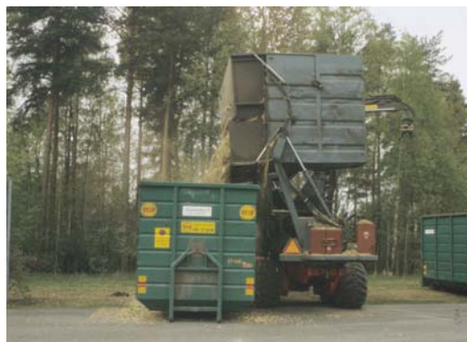
Joonis 3.12. Mobiilse hakkuri konteineri tühjendamine, P.Muiste foto
