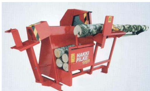
Joonis 3.50. Halumasin Hakki Pilke Eagle kiilkoonuse ja ketassaega [38]
