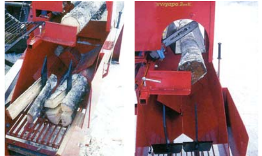
Joonis 3.52. Kombineeritud halumasin Japa 2000 [40]
