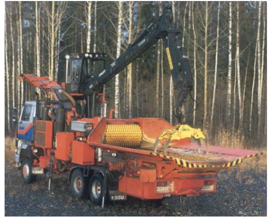
Joonis 3.41. Veoautole paigaldatud hakkur Giant [33]
