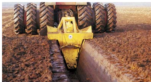
Joonis 3.65. Kuivenduskraavide pressimine raba pinnasesse seadmega OJ-1.3K Soome firmalt SUOKONE OY
