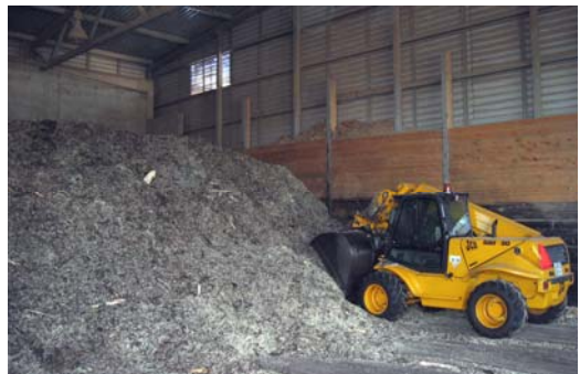
Joonis 5.3. Frontaallaaduriga traktor kütuse põhilaos Peetri katlamajas, foto Ü.Kask
