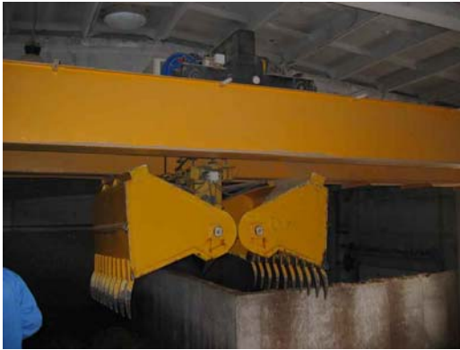
Joonis 8.39. Eestis valmistatud greiferiga sildkraana, foto Ü.Kask
