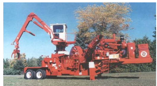
Joonis 3.43. Treilerile paigaldatud ketashakkur Morbark 30 [33]
