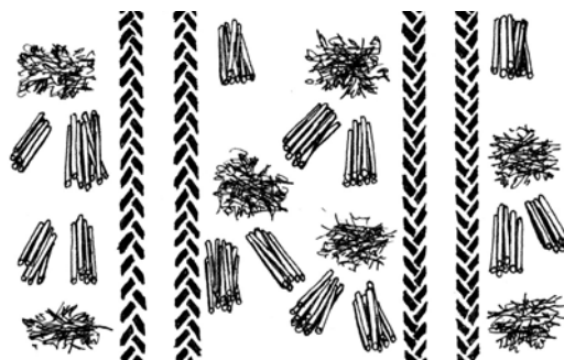
Joonis 3.9. Raietööde käigus on soovitatav laasitud oksad paigutada eraldi
