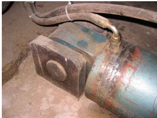
Joonis 8.30. Keevitatud hüdrosilindri ots, foto Ü.Kask
