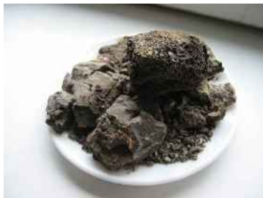
Joonis 8.8. Kõvastunud tuhasadestised kaarvõlvilt, foto Ü.Kask
