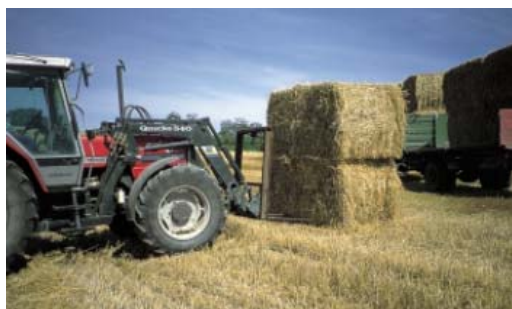
Joonis 3.62. Põhupallide laadimine traktorile monteeritud frontaaltõstukiga [43]
