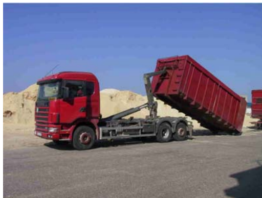
Joonis 3.20. Hakkpuidu transport konteinerveokiga, P.Muiste foto
