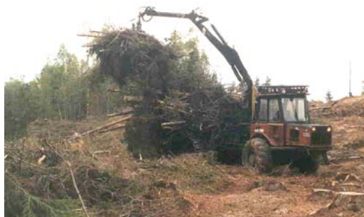
Joonis 3.14. Raiejäätmete kogumine langil, P.Muiste foto
