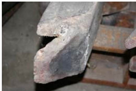
Joonis 8.15. Põlenud esiotsaga restilüli, foto Ü.Kask
