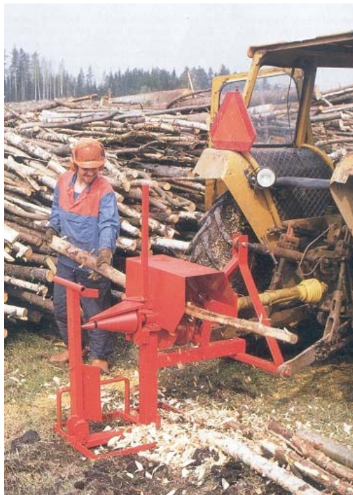
Joonis 3.49. Kiilkoonusega puulõhkuja kombineerituna koorijaga [37]
