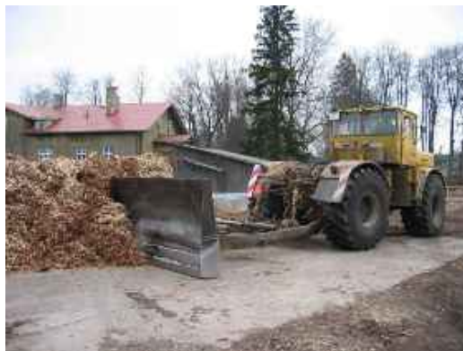
Joonis 8.32. Kütuse tõukamiseks kohandatud traktor, foto Ü.Kask)
