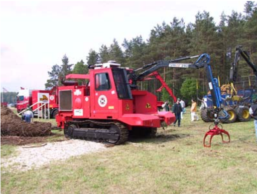
Joonis 3.40. Ekskavaator hakkuri alusmasinana, P.Muiste foto
