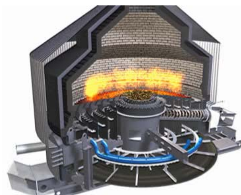
Joonis 4.6. Wärtsilä patenteeritud koonilise restiga altsöötmisega kolle BioGrate
