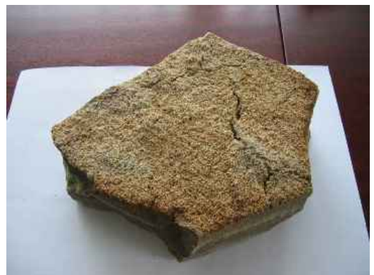
Joonis 8.41. Koldest eemaldatud sadestise tükk, foto Ü.Kask
