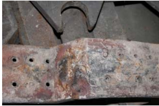
Joonis 8.14. Aasta aega katlas töötanud restilüli, foto Ü.Kask
