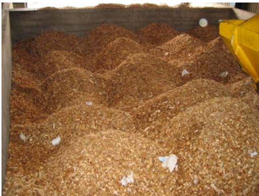
Joonis 8.10. Greiferkraana töötab laos automaatselt ja jaotab kütuse laos ühtlaselt, foto Ü.Kask
