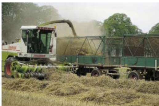
Joonis 3.60. Õlgede peenestamine ja peenestatult hoidlasse transportimine [43]
