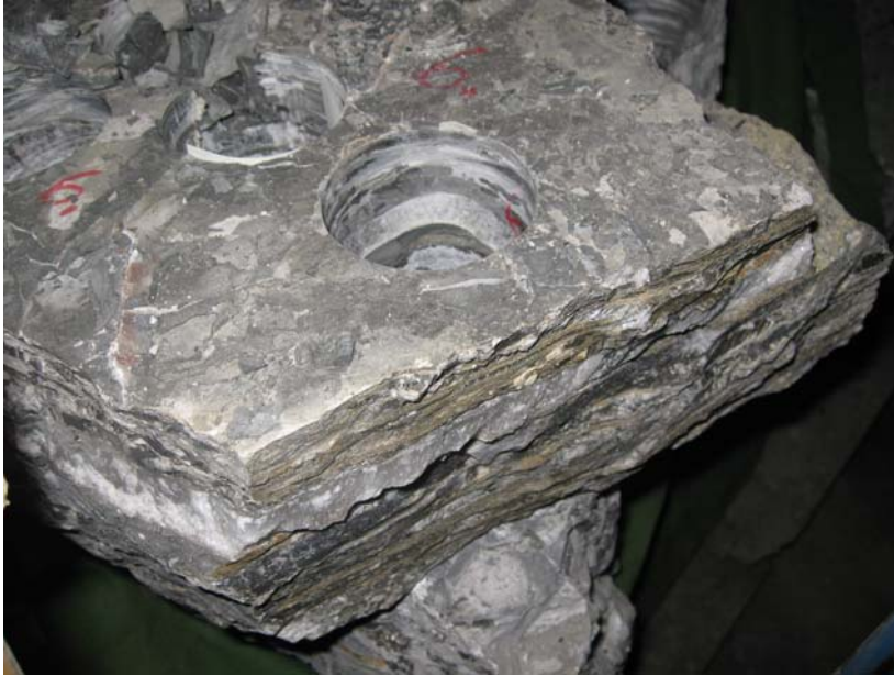
Joonis 33 Laboriuuringute peamine moodus on puursüdamiku testimine surve all. Saadud teavet kasutatakse tervikute püsivuse hindamisel ja täitematerjalide valmistamiseks. TTÜ mäeinstituudi ja Freibergi mäeakadeemia uurimused.
