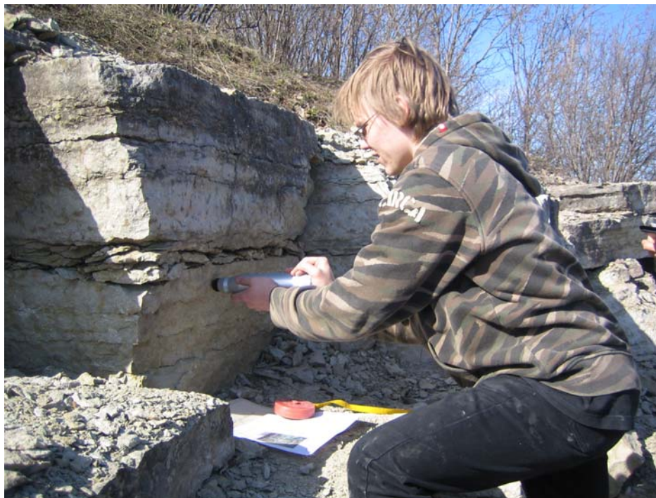
Joonis 28 Ekspressmeetodi rakendamine lubjakivi pinnakõvaduse määramisel. Ole Sein teadusklubi välitööl v
