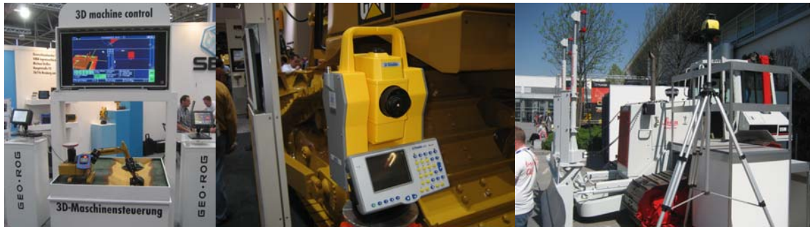
Joonis 26 GPSi ja geomeetriliste andurite abil muudetakse kaevandamismasinad robotiteks, mis suudavad täpselt ja efektiivselt kujundada projekteeritud maastikku
