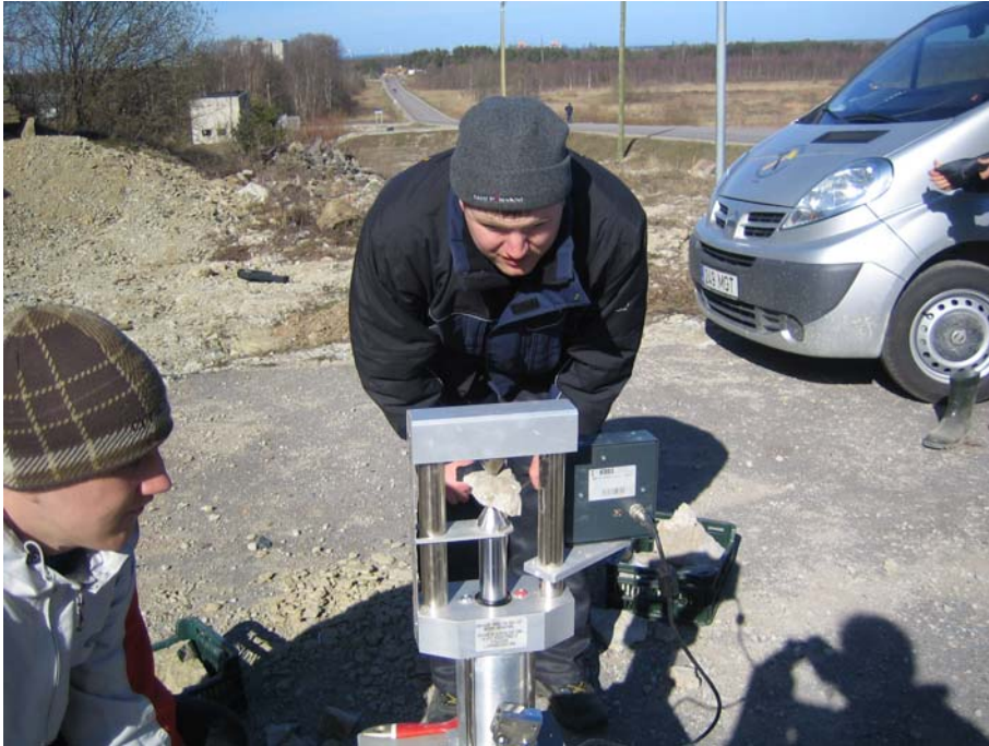
Joonis 29 Ekspressmeetodi rakendamine lubjakivi survetugevuse määramisel. Veiko Karu ja teadusklubi välitöö vi
