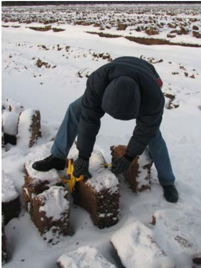
Pilt 8 Turbaploki mõõtmete kontroll
