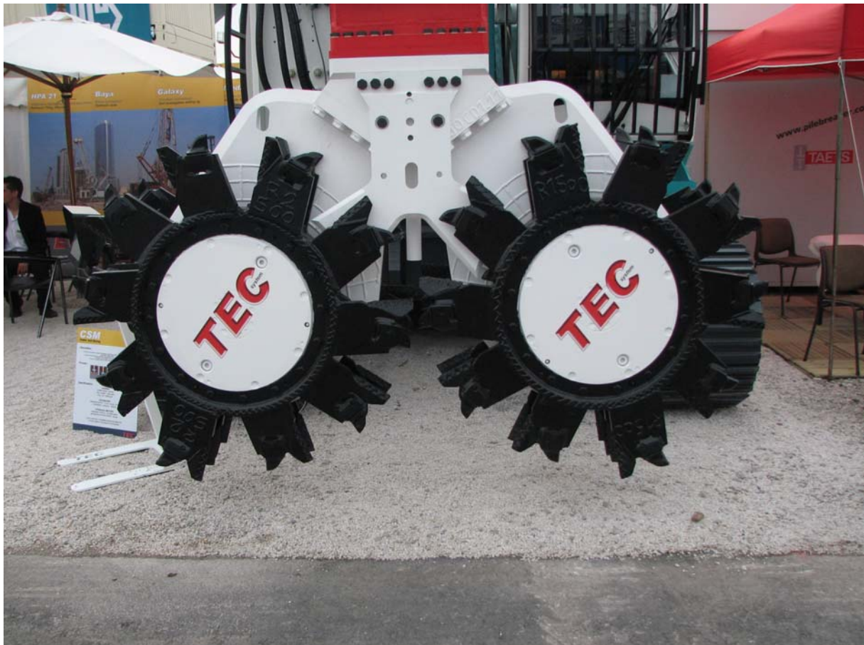
Joonis 25 Veekindlate seinate rajamiseks läbindatakse kaevanduste või kaitstavate objektide ümber mitmekümne meetri sügavune kraav, milles olev materjal segatakse väikese filtratsioonimooduliga ainega (N: bentoniit- vm. savi)
