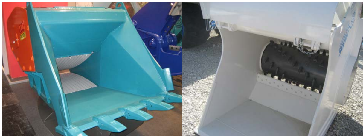
Joonis 27 Kopp-purusti võimaldab kaevandatavat materjali purustada ilma purustussüsteemita. Vähem masinaid tagab säästvama kaevandamise ja väiksema kulu
