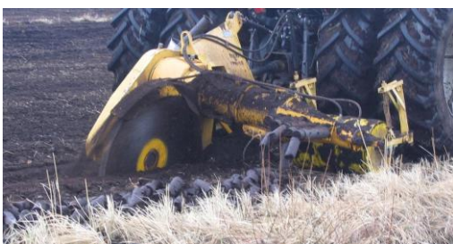
Joonis 91 Tükkturba tükkide pressimine (foto:A.Õnnis)
