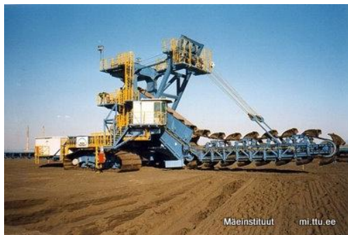
Joonis 100 Paljukopalise kettekskavaatori kopad
