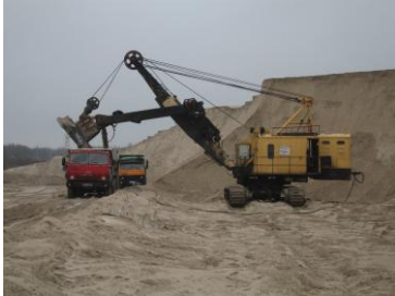
Joonis 60 Liiva laadimine mehaanilise labidaga (foto:A.Õnnis)
