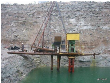
Joonis 92 Veekogur ja uputatud tsentrifugaalpump Aidu põlevkivikarjääris
