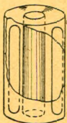
Joon.9. Isotoobi eraldamine termilise difusiooni meetodi abil (skeem)
