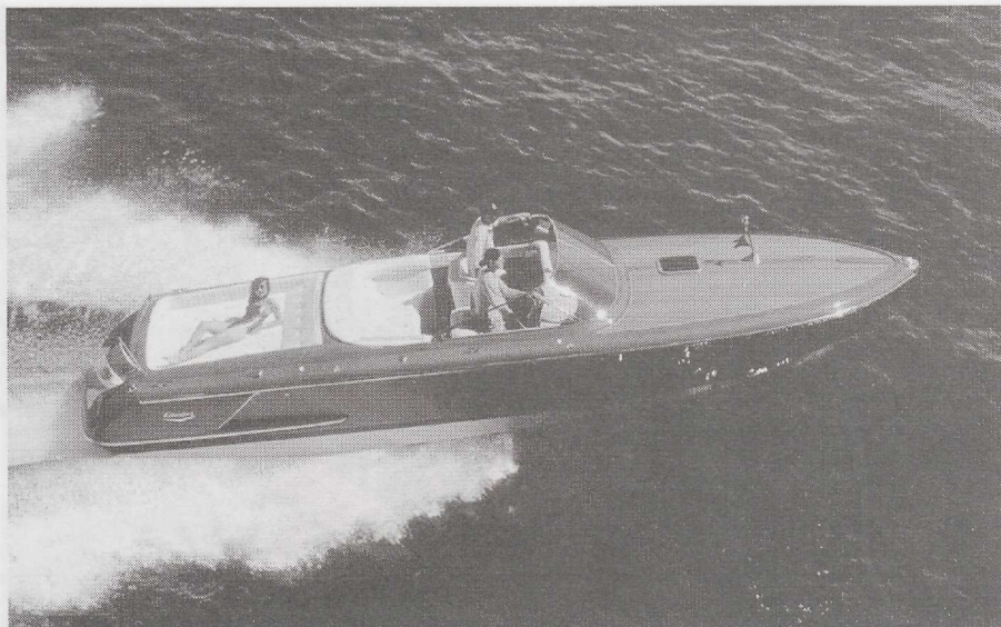
"Colombo" kiirpaatidel on kere veealune osa plastmassist, ülejäänu läikivast puidust.
