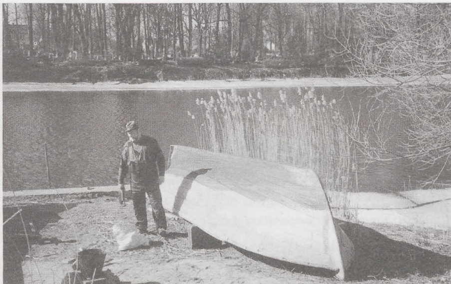
Enne tõrva pealekandmist peab paadipõhi peegelsile olema. Kalju Männikust ongi niikaugele saanud.
