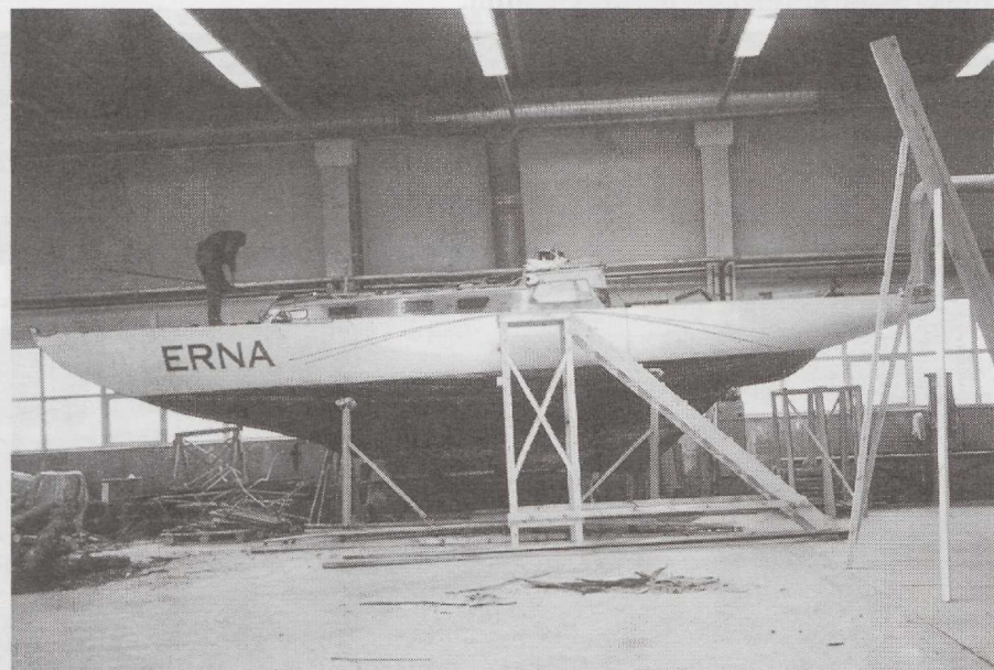
Venemaal 30 a. tagasi ehitatud puitjahi "Erna" omanik on puupaadifänn Pärnust. Tänavu kontrolliti keret ja tehakse uus tekk, tuleval aastal interjäär. Siis peab veel 30 aastat vastu.
