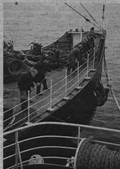
Kui esimene puksirots oli katkenud, võeti teine "Tõllule" peale "Tarmo" abiga. Et "Tõllul" polnud vintse, tuli see tömmata liini abil "Tarmo" kaudu peale.
