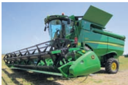
Kombainitootmises on võetud suund rootorkombainide täiustamisele. Hinnanguid on erinevaid, aga rootorkombaini peetakse viletsamates tingimustes suurema tööjõudlusega masinaks.
