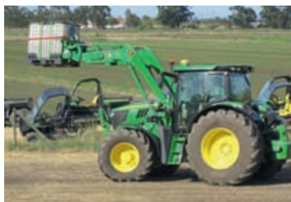
Elektroonilise paralleelsüsteemiga esilaadur võimaldab upitada esemeid, ilma et need loodist välja läheks.
