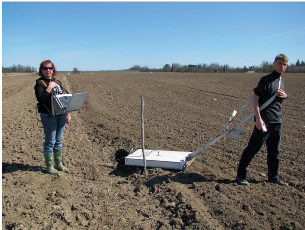
Antennid sagedusega 300 MHz paiknevad ühes kastis, mida veetakse enda järel. Teekonna pikkust ja elektromagnetimpulsi väljasaatmise hetke kontrollitakse kasti taga oleva mõõteratta abil. Mõõtmisi juhitakse ja tulemused salvestatakse sülearvutiga ühendatud portatiivseadme abil
