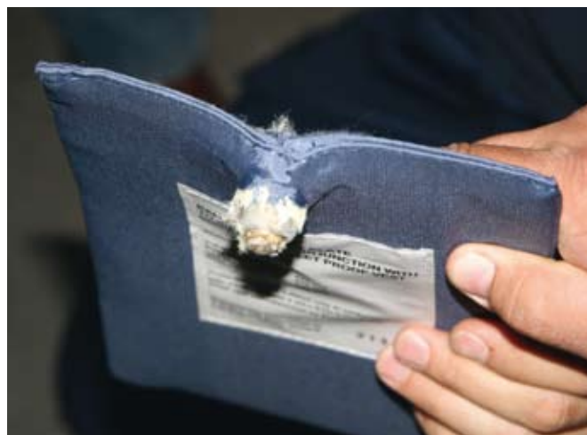
Proovilaskmise tulemused olid positiivsed. Kuulivestide ballistilised paneelid ja kaitsevesti täiendav kaitseplaat pidasid kinni kõik kuulid.
