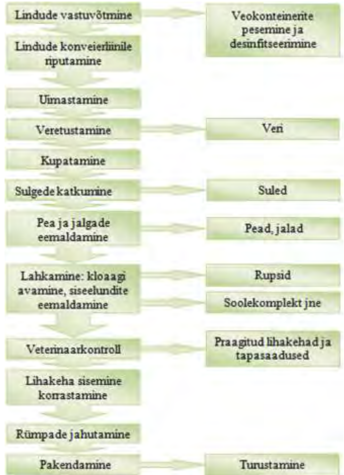
Joonis 2. Lindude töötlemise tehnoloogiline skeem
