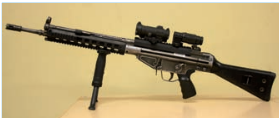
Rikkalikema varustuskomplektiga AK 4: laesäärele on kinnitatud tugijalaga lisakäepide ning lukukoja kaanel on punatäppsihik ja suurendusadapter. Suuremal osal täiustatud AK 4dest jääb originaallaesäär siiski vahetamata.
