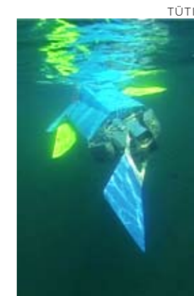
TUTU Tartu Ülikooli doktorant Madis Listak on ehitatud kalakujulise roboti, mida saab kasutada päästetöödel ja keskkonnauuringutel.
