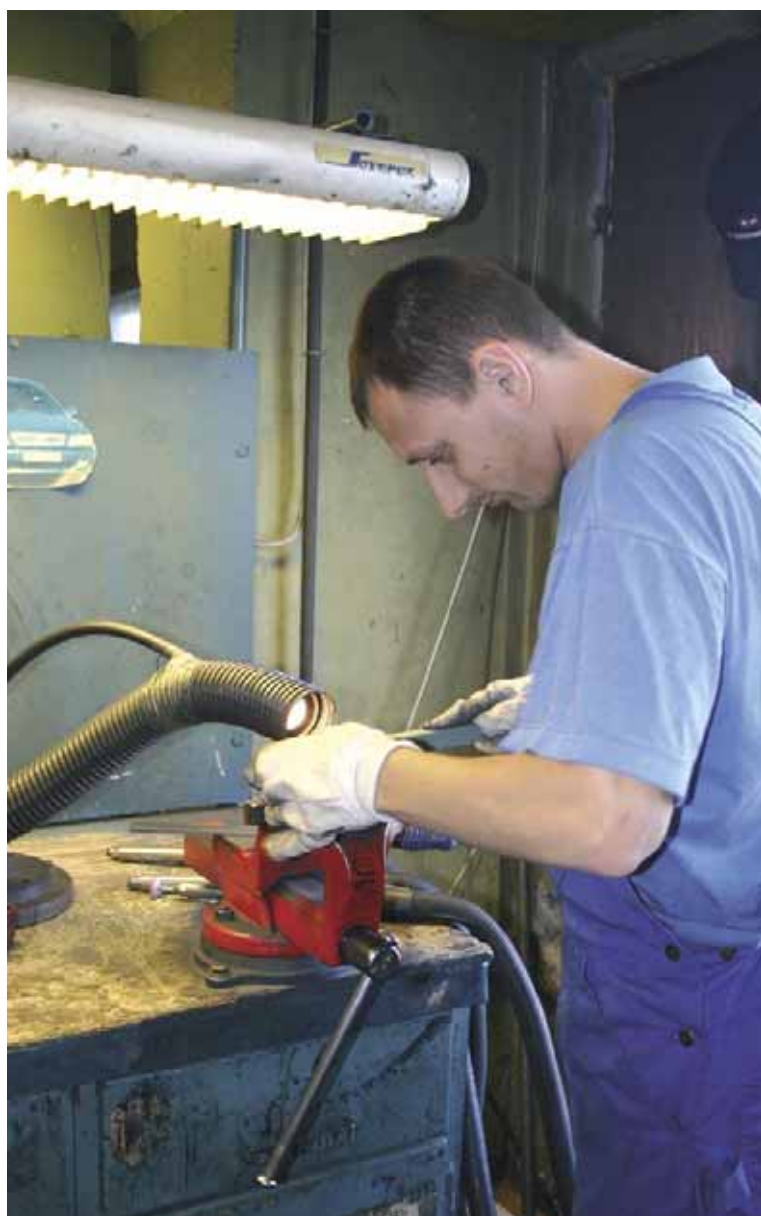
Kui pudelite vorme lihvides õhku sattuvaid tolmuosakesi ära ei imetaks, võiks see tekitada bronhiiti, kõha ja ülemiste hingamisteede ärritust.
