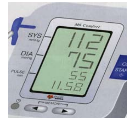
6. Lülita aparaaat sisse ja püsi liikumatult. Aparaat pumpab ise automaatselt manseti sobivalt täis. Kui manseti täitumine on lõppenud, algab mõõtmine. Mõõtmise ajal ära liigu ega räägi. Mansett hakkab vaikselt tühjenema, numbrid näidikul vähenema ja pulsinäitaja vilgub. Kui mõõtmine on valmis, tühjeneb mansett kiiresti täielikult ning saadud vererõhu- ja pulsinäit on aparaaadi näidikul.
