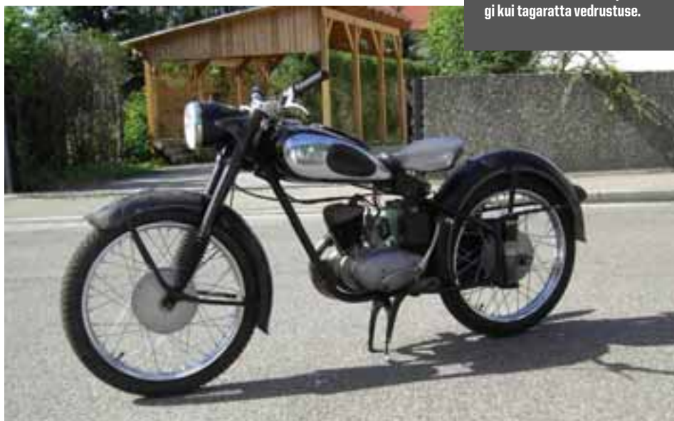
DKW ja MZ sõjajärgsed mudelid said endale nii teleskoopsehargi kui tagaratta vedrustuse.
