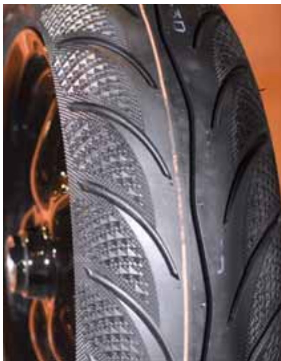
Rehviaärtel olev mikromuster peaks parandama pidamist märjal ja lubama tavarehvide vihmarehvide võrreldavaid kurvikiiruseid.
