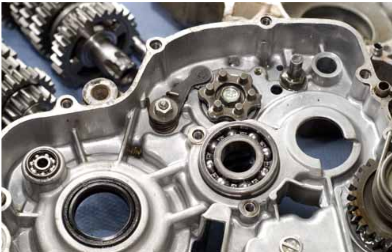
Väntvõlli laagrid on hea õli kasutamise korral pikaajalised detailid.
