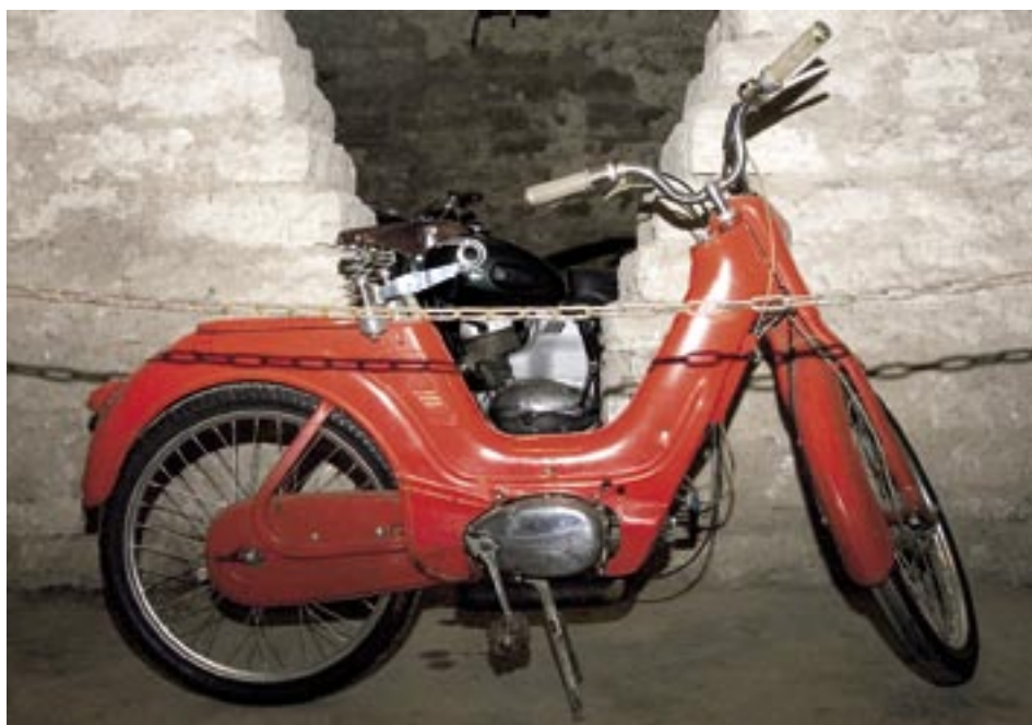
Vihur Rotax 125 mudel V.M. 209 (1985 ENSV!) 125 ccm, 35 hj, 85 kg, kuni 180 km/h, Mootorrattamuuseumist. Sarnaseid Vihur Rotaxeid tehti vaid kümme konda. Mootorile on 1987. a tehtud Lembit Teesalu tuuning. Oma viimased sõidud tegi tsikkel lätlaste valduses, kus ta peale kepsu purunemist seisma jäi.
