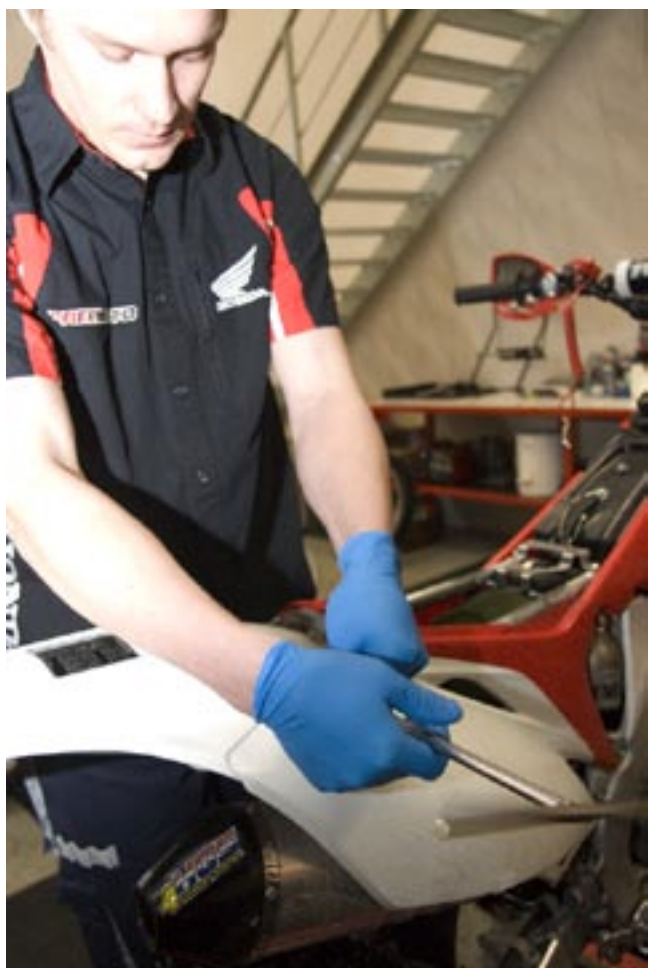
Filtrit hoiab paigal kas tsentraalmutter või klamber. Hondadel (pildil) on selleks liblikmutter.
