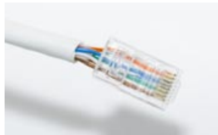
6. Surun eraldatud kaabliotsad õiges järjekorras 8P8C kaablipistikusse.
