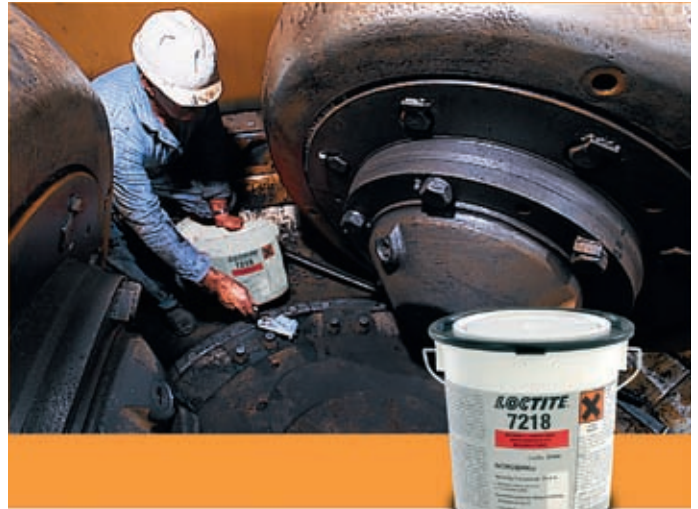
Hõõrdumiskindla pinna taastamiskihhi pealekandmine: Loctite Nordbak Wearing Compound 7218.
