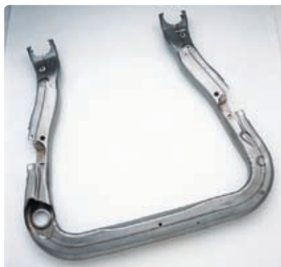
T 3 -PROFILEERIMIST KASUTATAKSE PEAMISELT TERASLEHTEDE TOORIKUTEST SULETUD ÕONESPROFIILIDE SAAMISEKS.
