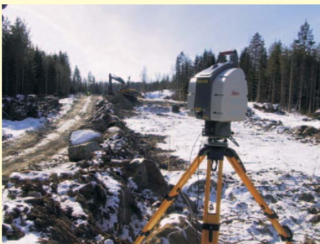
Pilt: Laserskanner (Leica HDS3000) teetöömaal
