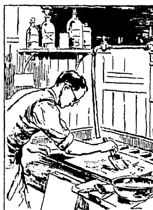
8. Tsinkplaadi-pildi süütmise happesse kustatud pinsli abil.
