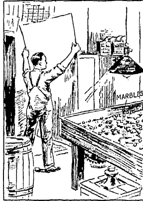
11. Alumiiniumilehe puhastamine veerlev. marmorkuulikeste abil.
