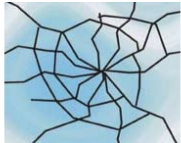
Joonis 1. Klaasi purunemine löögi toimele.
