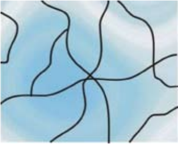
Joonis 3. Klaasi purunemine temperatuuri toimel.
