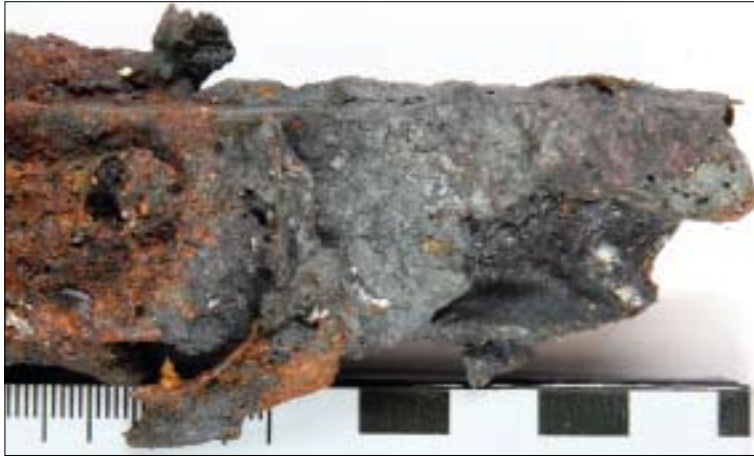
Foto 13. Vedelas olekus alumiiniumi toime terasele.
