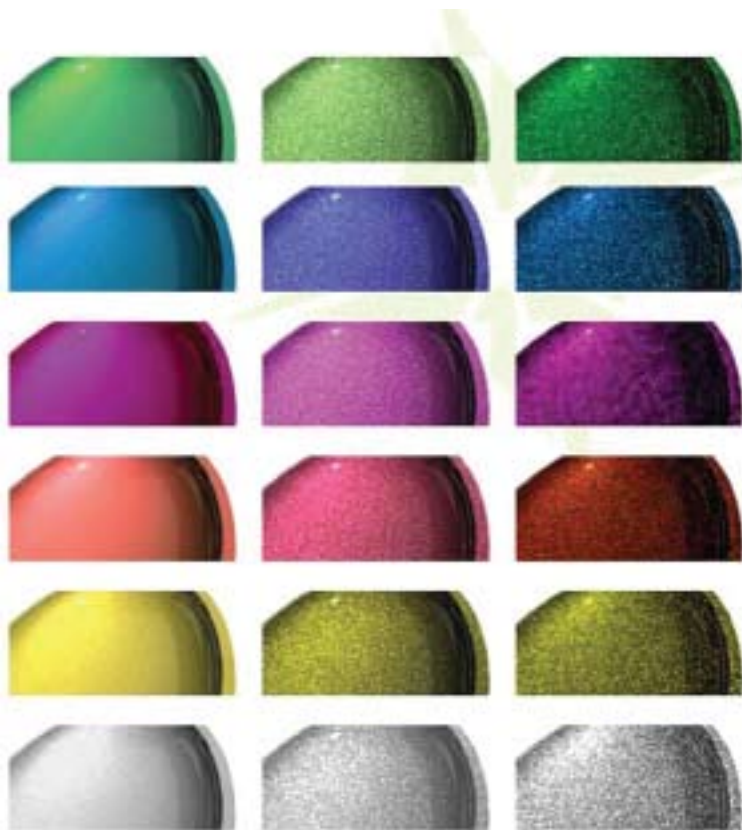
Pigmentiosakeste suurus ja efektpigmentiosakeste sisaldus mõjutavad värvipigmentide toone.
