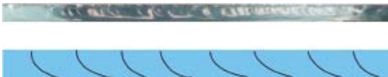
Joonis 2. Kaarjad struktuurid löögi tagajärjel tekkinud murdepinnal.
