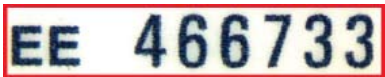
Tindipritstehnikas seerianumber võltsitud dokumendil, kujutiste servad on tindipritsimetodile iseloomulikult "karvased".
