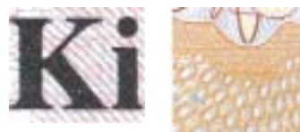
Ofsettrüki näide ja kuivofsetis trükitud fragment.
