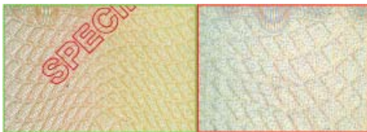
Iiristrükk kuivofsetis originaalil/turvatrükisel. Sama kujutis võltsitud rasterofsetiga.
