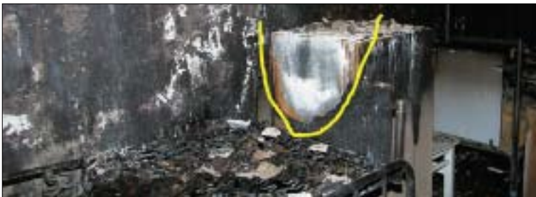
Foto 5. Tulekahjukolde asukohale viitav koonuse jälg külmiku seinal.
