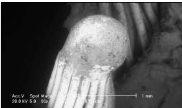
Foto 10. Kerakujuline kaarleegi jälg elektrijuhtme otsas elektronmikroskoobis.
