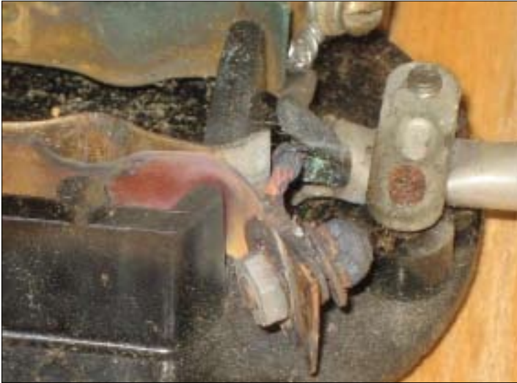
Foto 16. Suure kontaktakistuse tunnused (vaskdetaili värvimuutus) pikendusjuhtme kontaktpesas.
