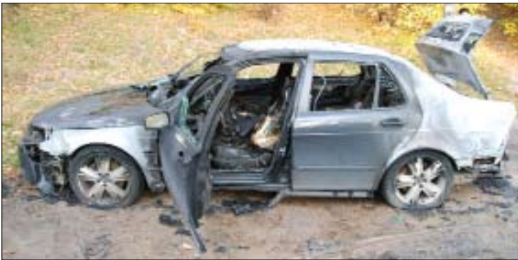
Foto 1. Sõltumatud tulekahjukolde sõiduki esi- ja tagaosas.
