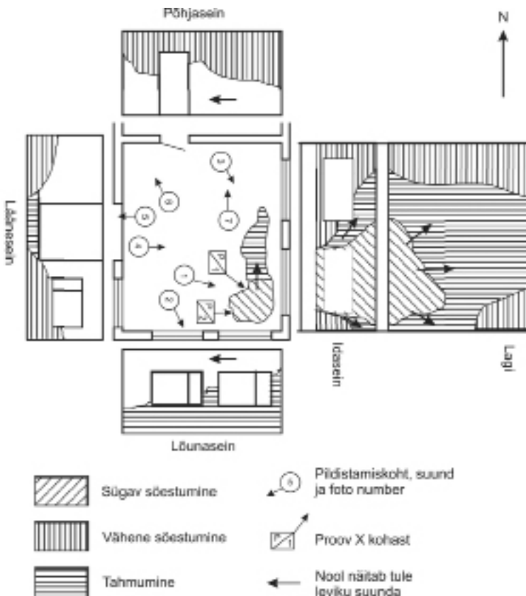
Joonis 3. Põlemisjäljed tarinditel (NFPA 921 2001: 104).
