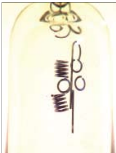
Paremal esilatena lähitulede hõõgniidi deformatsioon, vasakul väljalülitatud halogeenlambi purunenud hõõgniit.
