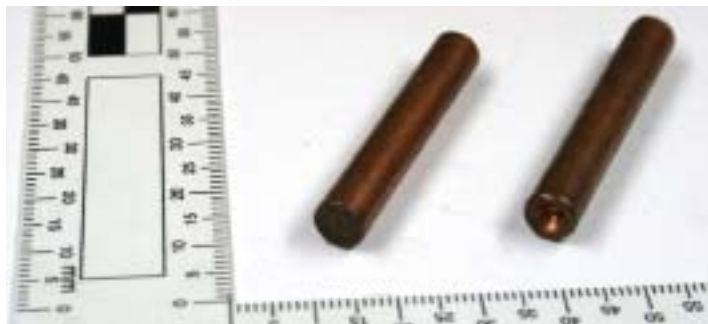
Foto 1. Kapseldetonaatorid, paremal kumulatiivnõoga detonaator.
