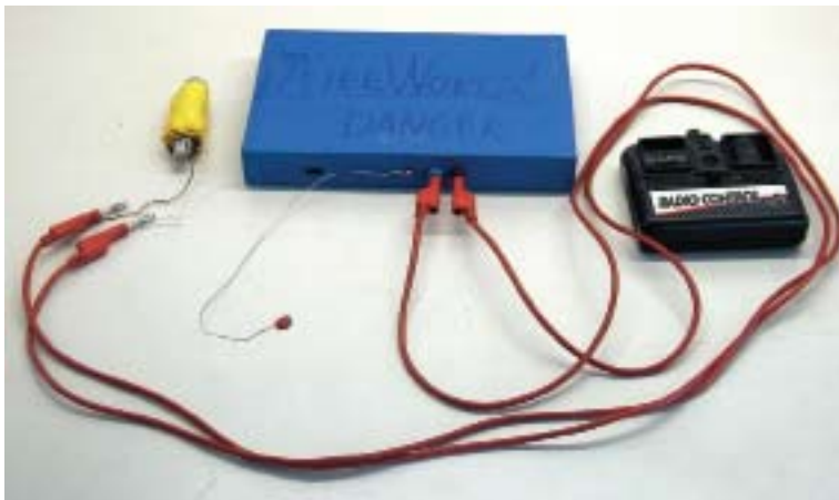
Foto 12. Distantsilt käivitav isevalmistatud lõhkeseadeldis.
