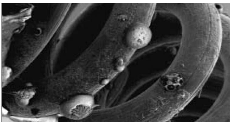
Hõõgniidi mikroskoopiline uurimine. Ülemisel fotol on kaarleegi toimel tekkinud sulamisjälg pingestatud hõõgniidi katkenud otsal. Alumisel fotol on lambi klaaskolbi purunemisel kõrgetemperatuurilise hõõgniidi külge sulanud klaasi tilgad.
