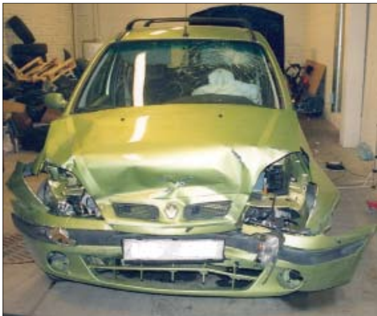
Näide sõiduki vigastuste ulatusest, mille korral tekivad esitulede lampidel selged tunnused.
