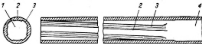
Joonis 2. Vintlõigetega relvaraud. 1 – relvaraua õõs, 2 – vindiväljad, 3 – vintlõiked, 4 – padrunipesa.
