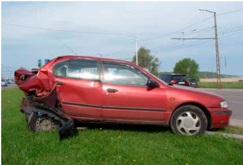
Foto 4. Auto, mis on saanud löögi tagant ja deformeerunud tagasuunal.
