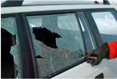
Foto 24. Aknaklaasi lõhkumine spetsiaalse klaasipurustajaga.
