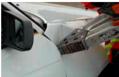
Foto 36. Laiendi asetamine avasse ukse hingedelt rebimiseks.
