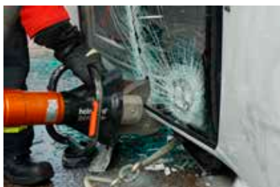
Foto 52. Alumise külje postid tuleb lõigata läbi kindlas järjekorras: A, C ja B post.
