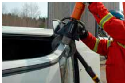
Foto 51. Katuse eemaldatakse hüdraulilise lõikuriga.
