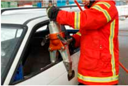
Foto 30. Esiukse avamiseks pigistatakse uks luku kohalt laiendiga kokku.
