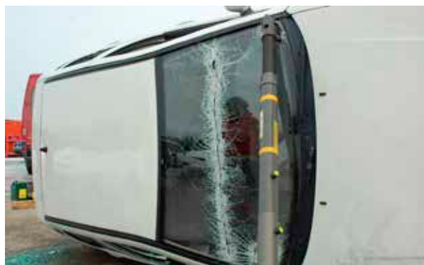
Foto 50. Autokatuse eemaldamiseks lõigatakse läbi esiklaas.
