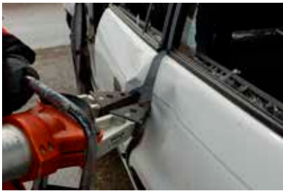
Foto 32. Ukseluku puruksrebimine laiendiga.
