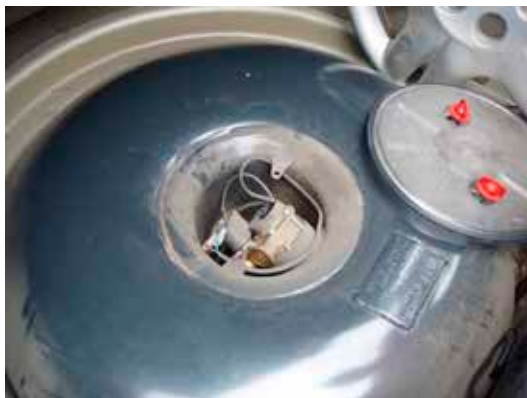
Foto 20. Gaasiballoon paikneb sõiduauto-del pagasiruumis või tagavararatta koogas.
