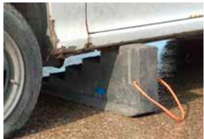
Foto 23. A-postidest tahapoole paigutatud puuprussid või spetsiaalne stabiliseerimiseks mõeldud astmestik.
