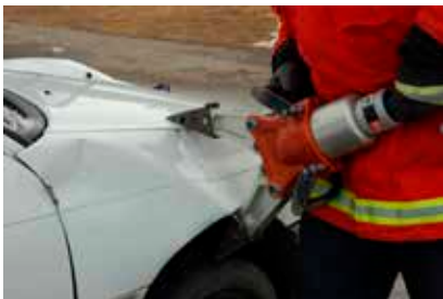
Foto 34. Laiendi tööelemendile tugipunkti tekitamiseks vajutatakse kokku auto esitiib.
