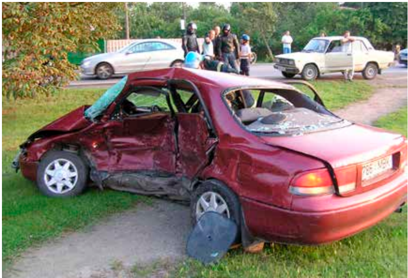
Foto 5. Külgsuunalt löögi saanud auto kere deformeerub saadud löögist terve külje ulatuses.
