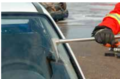
Fotod 28 ja 29. Auto aknaklaasi avamine Hooligan kangi abil
