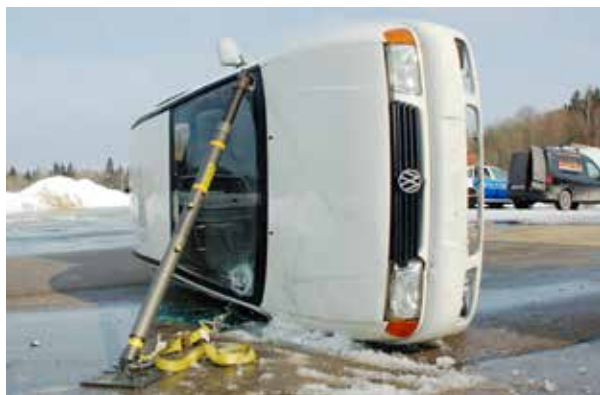
Foto 49. Vrahi külge rihmaga kinnitatud toetussüsteem.
