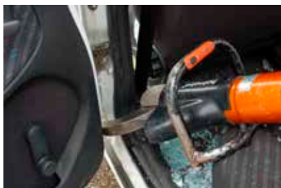
Foto 40. B-post tuleb lõigata läbi ülevalpool alumist uksehinge.
