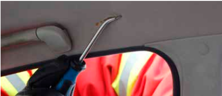
Foto 19. Et vältida pürotehnilise laengu lõhkilõikamist, tuleb spetsiaalse töövahendiga avada salongi polster.
