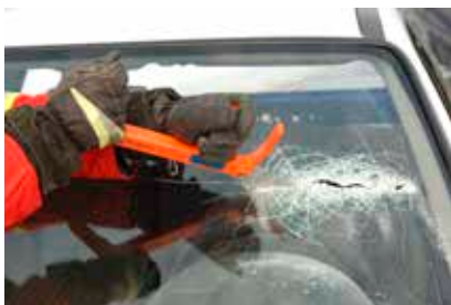
Foto 27. Auto aknaklaasi saagimine klaasisaega.
