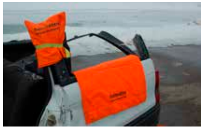
Foto 47. Vraki teravate servade katmine spetsiaalse kattega.
