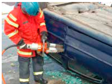
Foto 57. Ukse avamine laiendiga, mille asetamiseks on varem Hooligan kangiga avaus tehtud.
