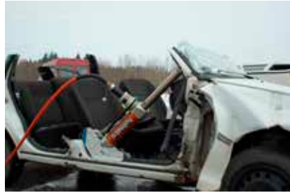
Foto 45. Mootoriosa tagasisurumine tungraua abil.
