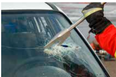
Fotod 28 ja 29. Auto aknaklaasi avamine Hooligan kangi abil
