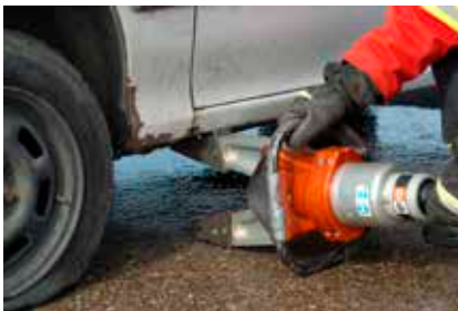
Foto 22. Autokere kergitamine hüdraulilise laiendiga.
