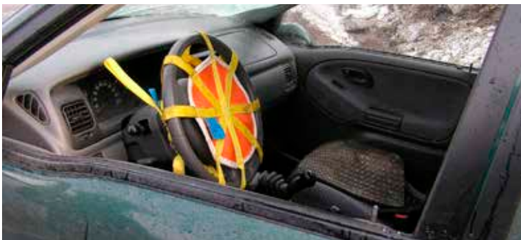
Foto 18. Autojuhi turvapadja saab kinni katta spetsiaalse rakisega.
