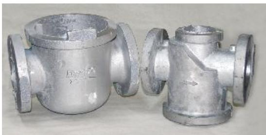
Выпускают различные марки литейных алюминиевых сплавов, которые по химическому составу можно разделить на группы. Например: •алюминий с кремнием (**силумин**); •алюминий с магнием
