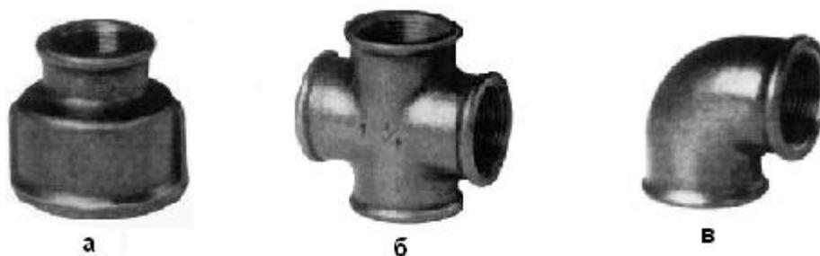
Рис.1.2.3. Фитинги для трубопроводов из ковкого чугуна: а – муфта переходная; б – крест; в – угольник.
