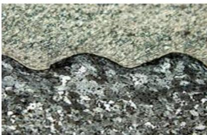
Основная масса биметаллов представляет собой сталь: подложка – из конструкционной углеродистой стали; плакировка – из нержавеющей хромоникелевой стали. Правильно выбранный способ антикоррозионной защиты позволяет обеспечить максимальную долговечность химического оборудования в конкретных условиях его эксплуатации.
