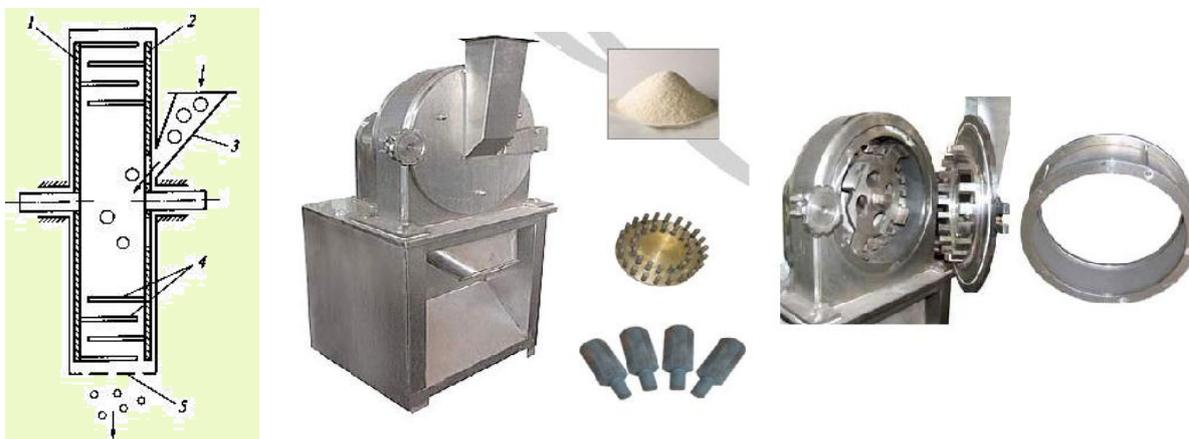
Рис.2.14.8 Дезинтегратор и его составные части: 1,2 – роторы; 3 – воронка; 4 – пальцы; 5 – решетка
