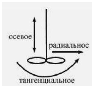
**Радиальное** течение характеризуется направленным движением жидкости от мешалки к стенкам аппарата перпендикулярно оси вращения мешалки.
