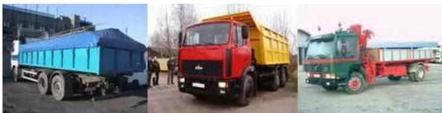
Рис.3.1.2. Открытые и закрытые самосвалы для доставки твердых и сыпучих материалов.
