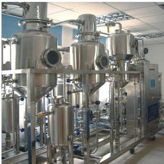
Рис.2.11.5. Установка многократной экстракции для изготовления лекарственных препаратов
