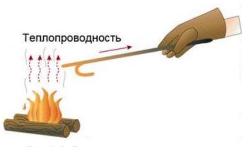
**Теплопроводность** ( $\text{Вт/(м}\cdot\text{К)}$ ) - это способность металлов передавать тепло от более нагретых к менее нагретым участкам тела (Рис. 1.1.5). Серебро, медь, алюминий обладают большой теплопроводностью. Железо имеет теплопроводность примерно в 3 раза меньше, чем алюминий и в 4 раз меньше, чем медь.
