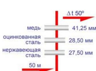
**Тепловым расширением** ( $\text{К}^{-1}$ ) называют способность металлов увеличиваться в размерах при нагревании и уменьшаться при охлаждении. На рис. 1.1.6 показано тепловое расширение одинаковых труб из различных материалов длиной 50 м при нагреве на 50 градусов.
