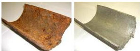
Химическое разрушение металлов под действием на их поверхность внешней агрессивной среды называют **коррозией** (рис. 1.1.7).
