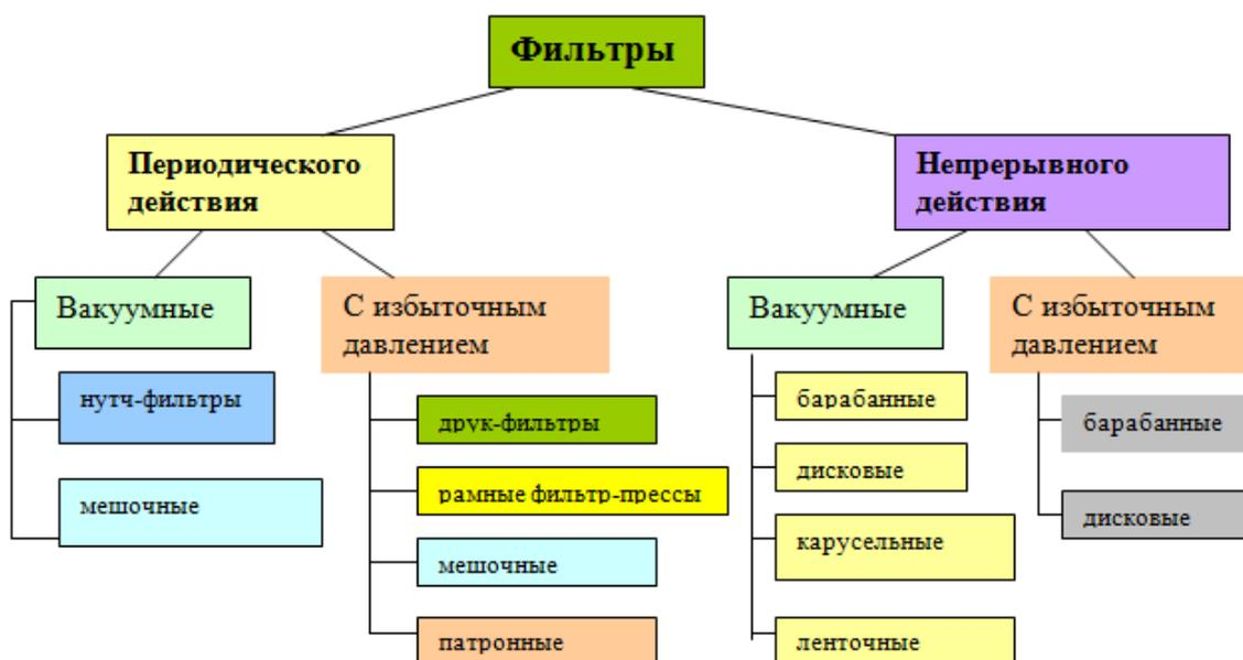
Рис.2.12.1. Классификация фильтров
