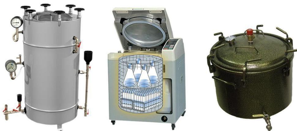
Рис.2.9.4. Автоклавы для стерилизации пищевых и микробиологических продуктов
