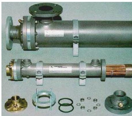
Рис. 2.6.9. Кожухотрубчатый теплообменник: - корпус (кожух); 2- трубные решетки; 3- трубы; 4- крышка; 5- днище; I, II – потоки теплоносителей
