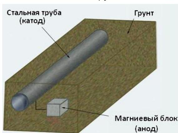
напряжения. В образованной таким путем гальванической паре металл протектора служит анодом. Он и будет постепенно разрушаться, а основной металл останется целым. Данный способ применяют для защиты конструкций во влажных грунтах. Стальные конструкции трубопроводов снабжают протекторами в виде пластин из цинка, алюминивно-цинковых или магниевых сплавов.
