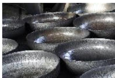
Рис.2.1.3. Эллиптическое днище аппарата
