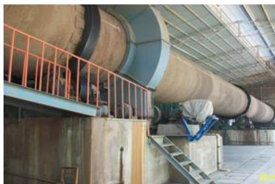
Рис.2.8.23. Роликовые опоры вращающейся печи
