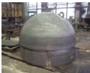
Рис.2.1.4. Сферическое днище аппарата
