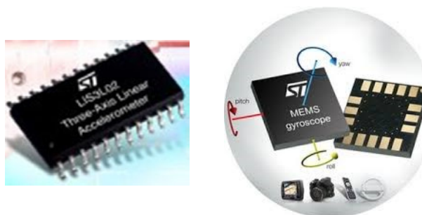
Joonis 6.8. Kolmekoordinaadiline mikro-elektromehaaniline kiirendusandur ja güroskoop MEMS
