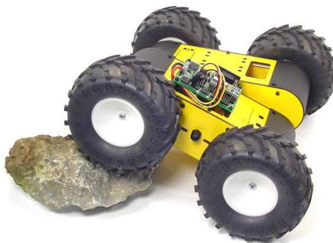
Joonis 2.25. Ebatasasel pinnal liikumiseks ettenähtud ratasveok
