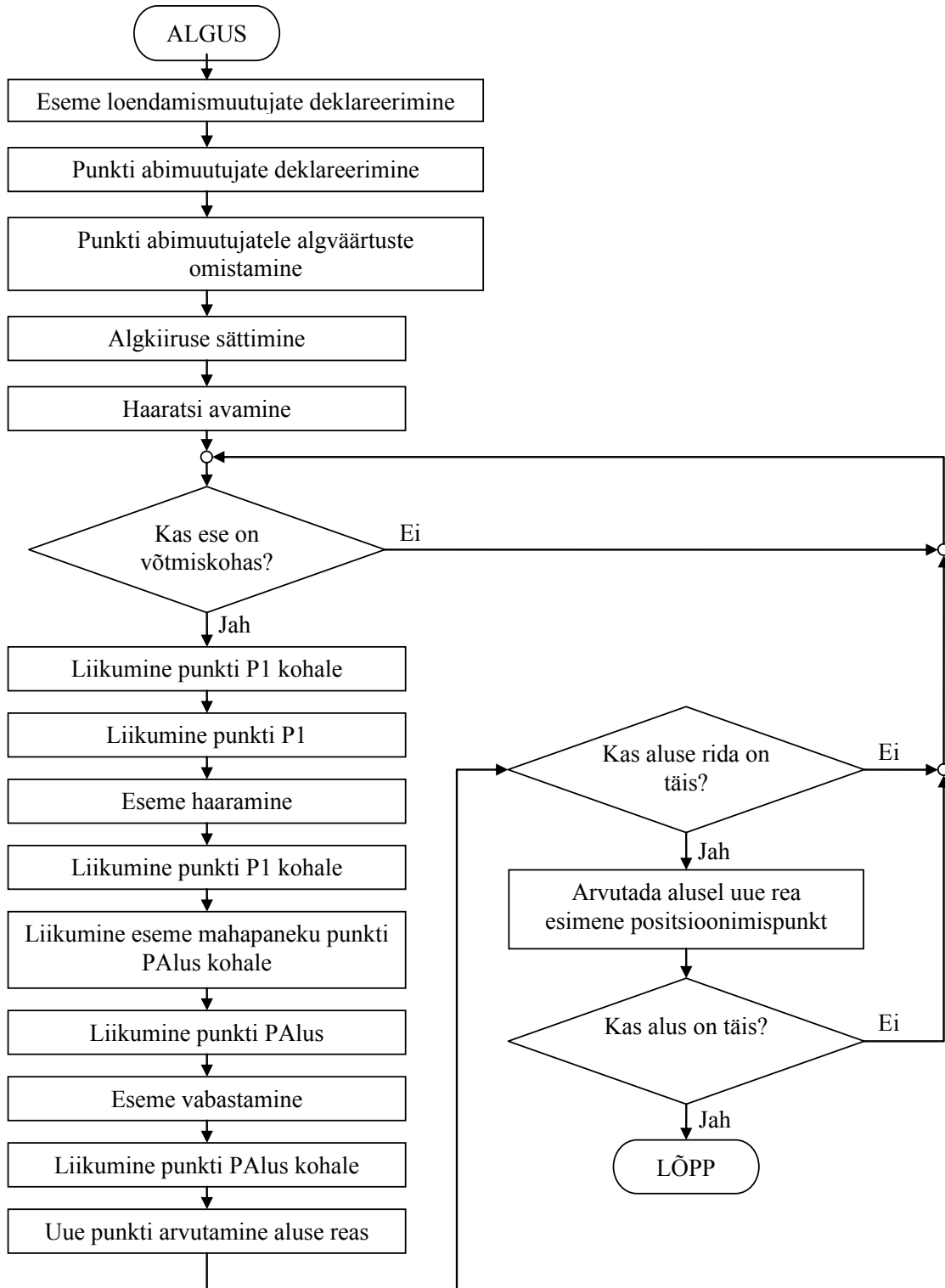
Joonis4.31. Roboti juhtimisprogrammi algoritm esemete ladustamiseks alusele
