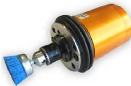
Joonis 3.32. Roboti tööriist töödeldavate detailide pindade puhastamiseks
