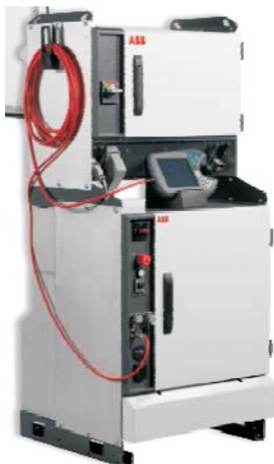
Joonis 4.15. Roboti juhtmoodul koos punktkeevitusplokiaga
