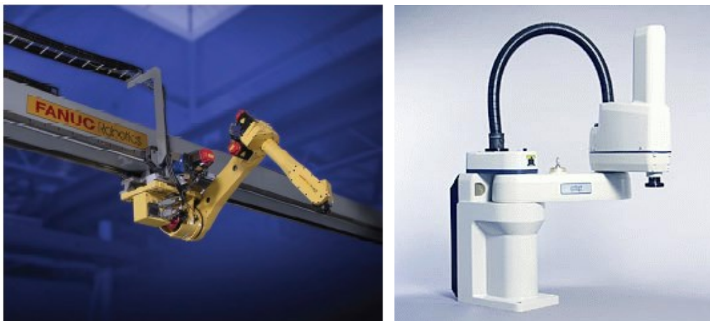
Joonis 2.11. Liigendkäega horisontaal- ja vertikaalteljega silindrilises nurkkoordinaadistikus töötavad robotid
