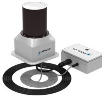
Joonis 6.27. Roboti töökeskkonna eeltuvastusseade 3D- Lidar (pilt on pärit Internetist)
