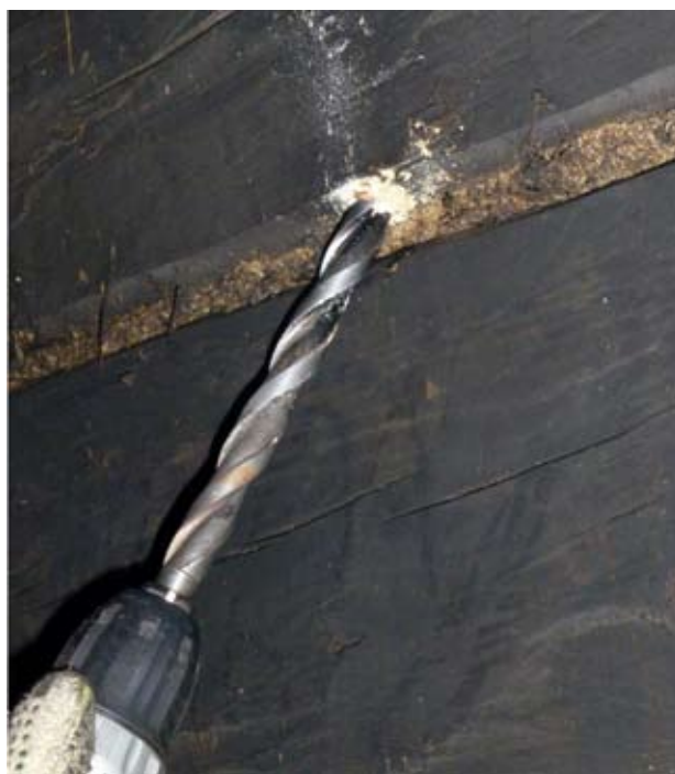
Joonis 3. Proovid võeti sauna siseseintest, puurides torupuuriga palgi poomkanti
