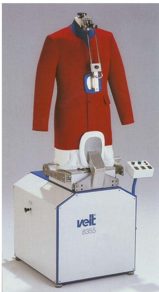
Joonis 60. Aurumannekeen koos hõlma paigalhoidjaga (tootekataloog Veit Kanneglessen Pressing for Excellence).
