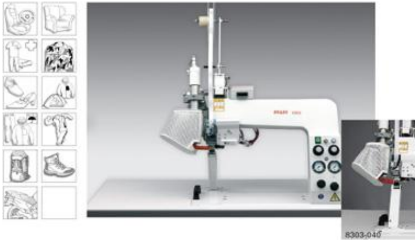
Joonis 80. Veekindlate õmbluste teipimismasin Pfaff 8303 ja kasutusvõimalused erinevatel toodetel (www.pfaff.com)
