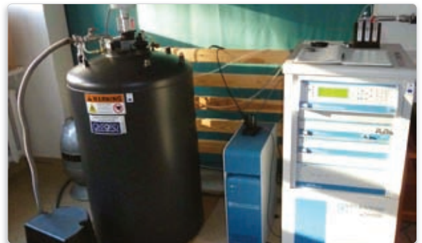
Ainete füüsikaliste omaduste mõõtesead 14T ülijuhtmagnetiga Physical properties measurement system with 14T superconducting magnet
