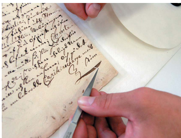
Foto 16. Indikaatorpaberi asetamine tindikirjale, foto: B. Haavasalu.
