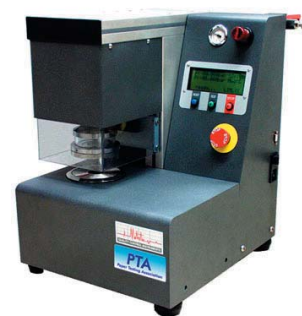
Foto 4. Seade survetugevuse mõõtmiseks.
