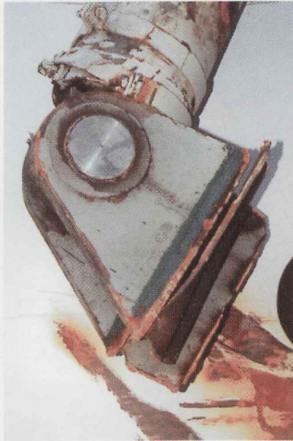
Joonis 8.26. Visiiri vasakparda käituri alumine ots.
