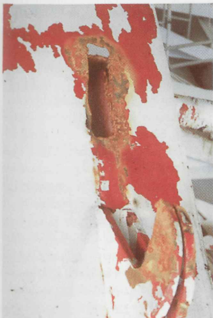
Joonis 8.19. Vasakparda külgluku kõrva väljarebimisest tekkinud vigastus ja käsiluku kõrvad.
