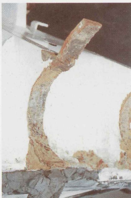
Joonis 8.23. Visiiri paremparda hinge purunenud vasakpoolne kõrv.
