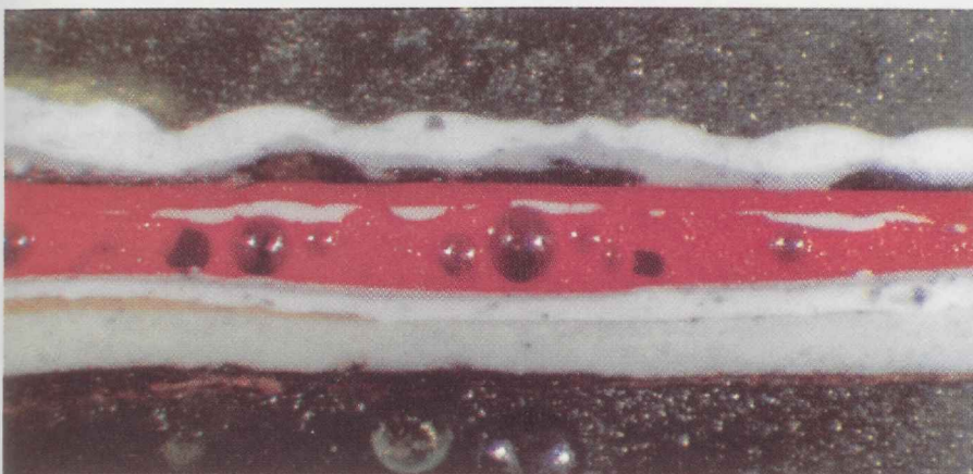
Joonis 12.20. Värviproovi ristlõige põhjaluku visiirikõrvalt.
