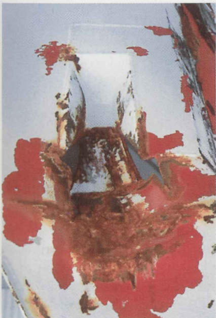
Joonis 8.8. Vasakparda fikseerimissarve süvendi vigastus.
