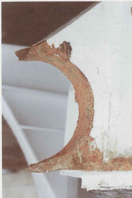
Joonis 8.22. Visiiri vasakparda hinge purunenud vasakpoolne kõrv.
