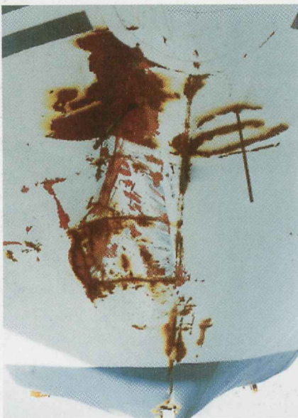
Joonis 8.5. Visiiri esikülje vigastused.
