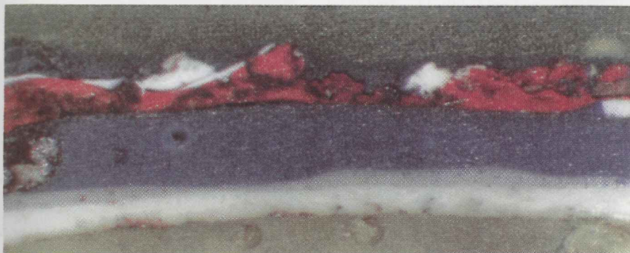
Joonis 12.19. Värviproovi ristlõige vööriigiteki parempoolselt kõrvalt.
