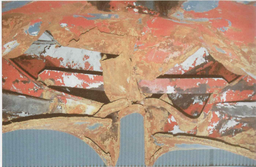
Joonis 8.6. Visiiri põhjakonstruktsiooni vigastused.
