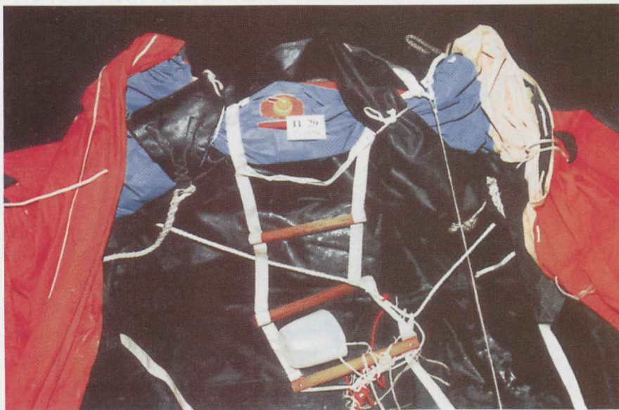
Joonis 17.9. Pärast õnnetust leitud ESTONIA päästeparve köied ja köisredel.
