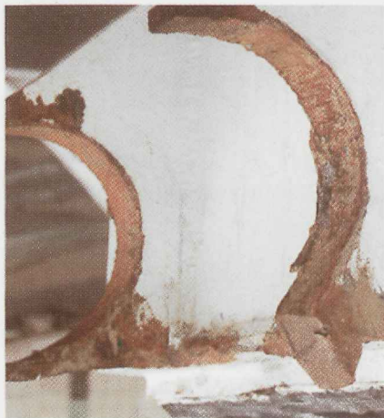
Joonis 8.21. Visiiri vasakparda hinge purunenud kõrvad.
