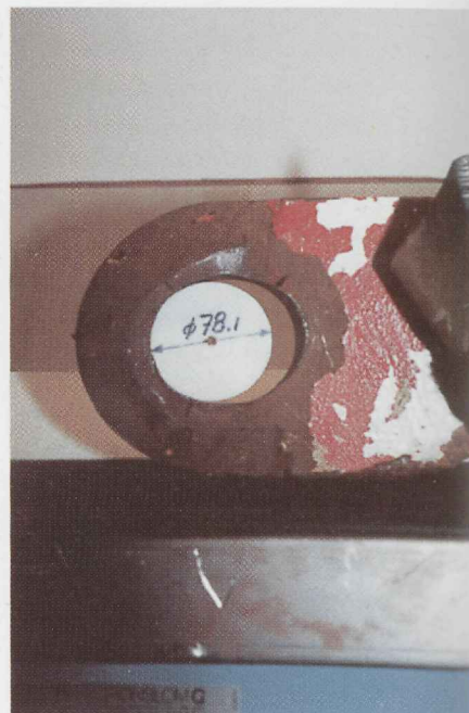
Joonis 12.17. Põhjaluku visiirikõrv (valge ketas näitab riivi ristlõiget).
