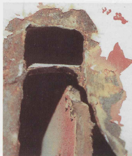
Joonis 12.23. Paremparda külgluku kõrva kinnituskoha purunemine horisontaalstringeri kohal.
