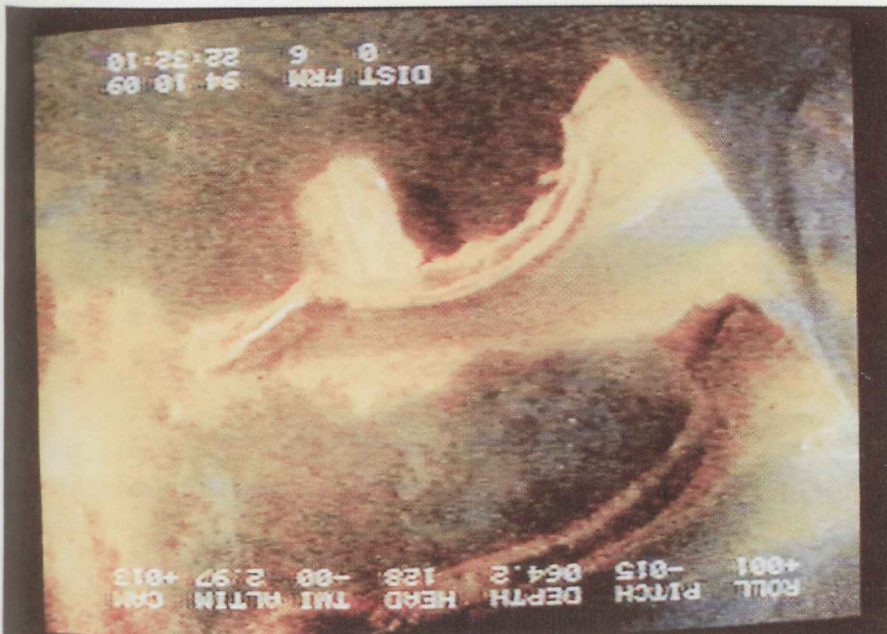
Joonis 8.14. Põhjaluku purunenud vasakpoolne ja keskmine kõrv.
