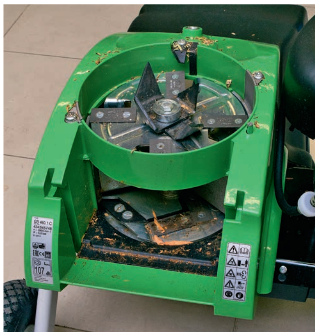
Kahe etteandeavaga oksapurusti sisevaade – pealmine ketas koos teradega on peenikese oksapudi jaoks, alumisse võib lasta jämedamaid roikaid.
