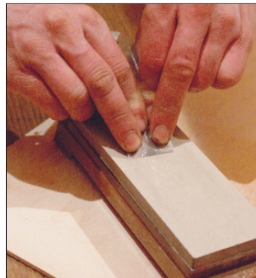
Käte asend teritamisel. Teritusel tuleks kasutada kogu luisu pinda, et luisk kuluks võimalikult ühtlaselt.
