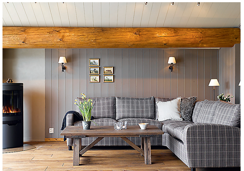
PUIT domineerib ka interjööris: põrand on valmistatud tammepuust, seinu ja lage katavad 145 mm laiused voodrilauad.
