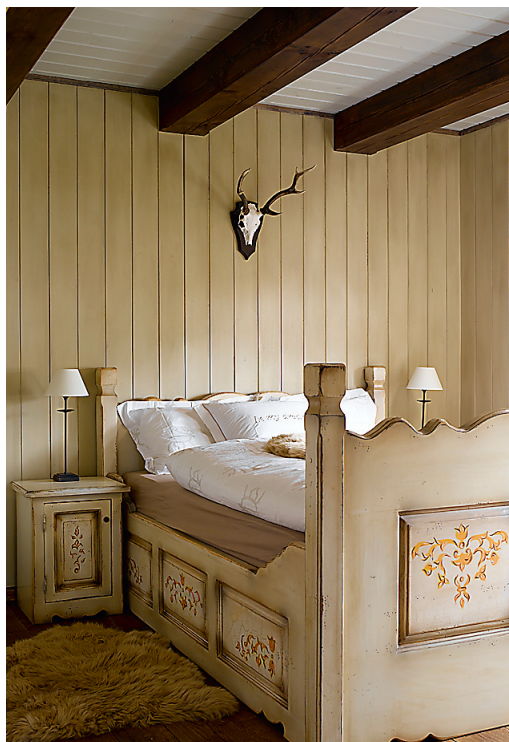
PUIT domineerib ka interjööris: põrand on valmistatud tammepuust, seinu ja lage katavad 145 mm laiused voodrilauad.
