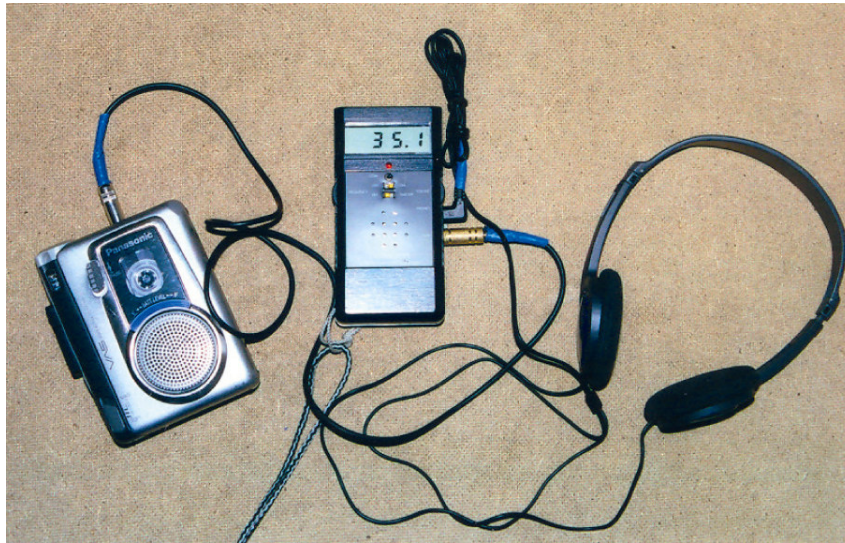
Joonis 2. Nahkhiirte detektoruuringu varustus. Vasakult alates: 1) Panasonic RQ-L30 salvesti, 2) Pettersson D240 detektor, 3) Panasonic RP-HT030 kõrvaklapid. Detektori sagedusnäidik on asendis 35 kHz, mis võimaldab korraga kuulda ultrahelisid vahemikus 30–40 kHz
