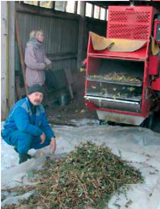
Rõugus kuivatatud sojataimede peksmine katsete koristuse kombainiga.
