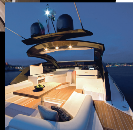
Kokpit, mille pehme katus on valmistatud epovaigust ja süsinikplastist.
