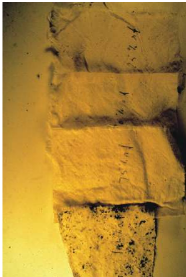
Joonis 16. Puuvillane kangas, mida hoiti temperatuuril 20 °C suhtelise õhuniiskuse poolest erinevatel tingimustel (100, 75, 50 ja 25%). 100% suhtelise õhuniiskuse korral on näha arvukalt hallitusseente kolooniaid, 75% õhuniiskuse korral ainult mõningaid ning 50% ja 25% suhtelise õhuniiskuse korral hallituste kasvu ei ilmnenu.
