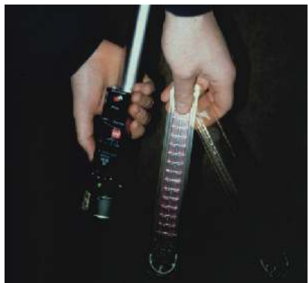
Joonis 4. Reuteri õhu analüsaator ja söötme täidetud plaadid, mis paigutatakse analüsaatori sisse. Analüsaatoris tekkiv tsentrifugaaljõud surub seeneeosed söötmele.
