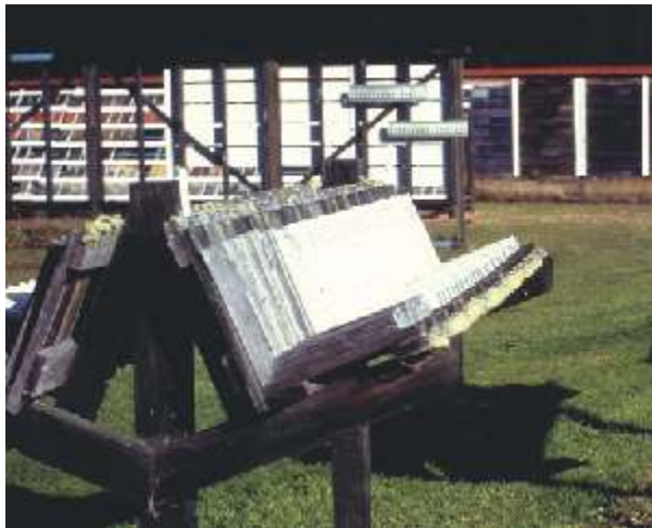
Joonis 28. Värvide vastupidavust valgusele, niiskusele, hallitus- ja puitu lagundavatele seenetele uuritakse välitingimustes.
