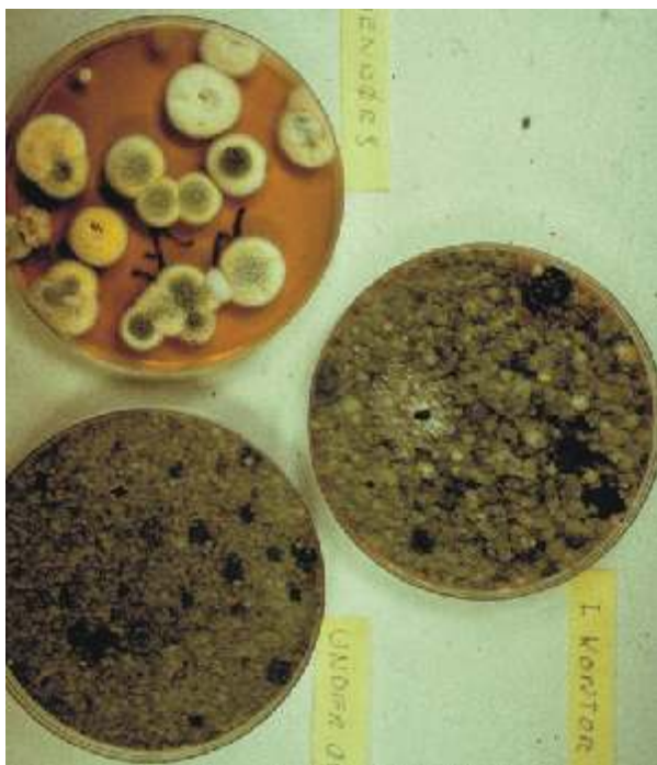
Joonis 8. Sadestusmeetodil võetud õhuproovid. Kaks alumist proovi pärinevad ruumidest, mille asukatel on sisekliima osas kaebusi ja kus esineb arvukalt hallitusseeni. Ülemine söötmeplaat on võrdlusanalüüs välisõhust. Söötmel kasvab 25 kolooniat, mis võrdub 12 500 CFU ruutmeetri kohta tunnis, kui söötmeid eksponeeriti viis minutit.
