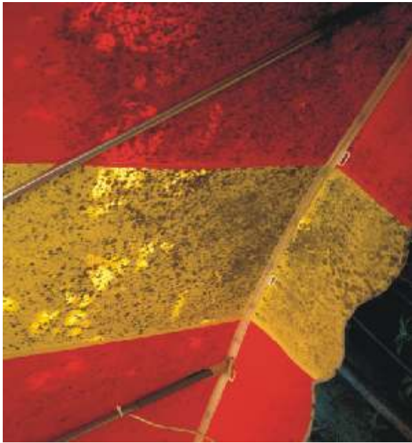
Joonis 22. Hallituseente poolt kahjustatud tekstiilist päikesevari. kaitsevahendiga.
