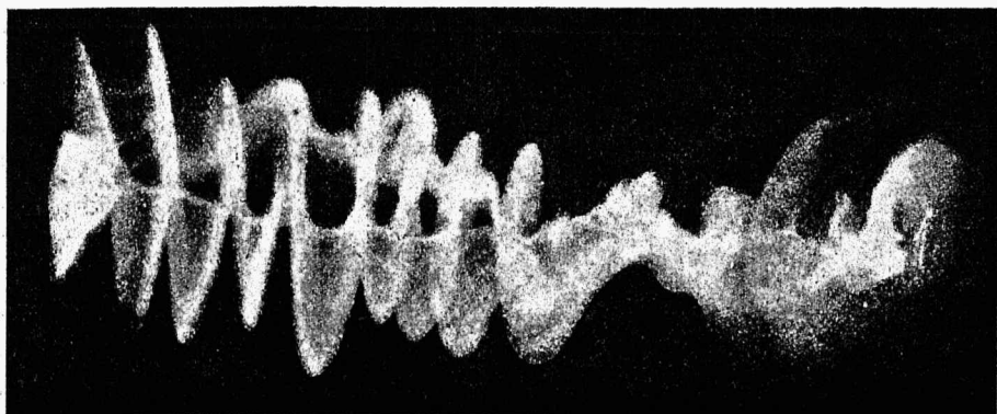
Joonis 4. Klingelfussi masina abil saadud säde laia ja heleda spiraaloreooliga.
