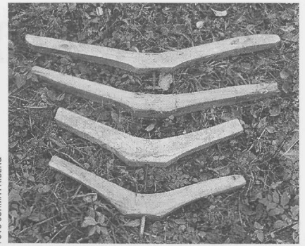
Det här är inga klädhängare utan kölmallar till två olika storlekar på båtar. De två övre kan vara till en båt i 6 meters klassen och den undre till en något mindre båt. Mallarna läggs tvärs kölplankan och anger på så sätt vinkeln på första bordet. Hittar du sådana på din gamla gård ta med dem till museet i Hapsal för att få dem dokumenterade.
