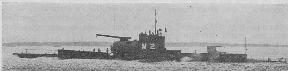
Briti allveelaev „M 2”. Pildil näha angaar ja kraana lennuki tõstmiseks.
