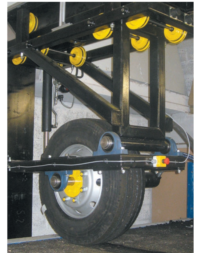
Teekonstruktsiooni katsetamine rataskoormusega tegelikkusele lähedastes tingimustes TTK teedelabori simulatsiooniseadmes.
