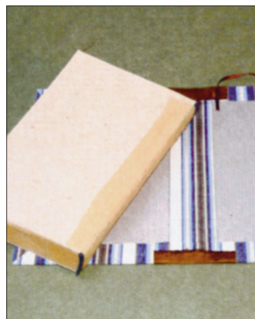
7. Katke kaaned. Selja mõõtudeks arvestage: köite sisu paksus + kaks kaanepapi paksust + 1 cm.
