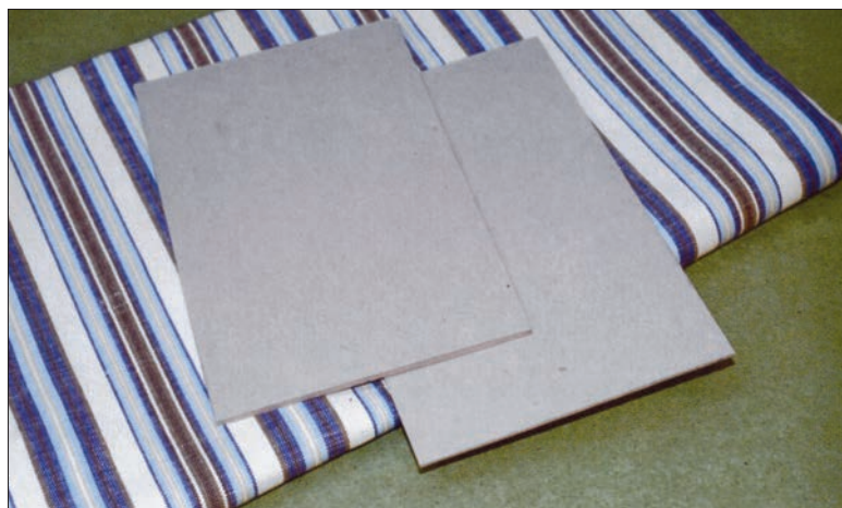
6. Valige välja kaane katmiseks sobivad materjalid ja lõigake köitepapist kaaned. Kaanepapi soovitatavad mõõdud: sisu kõrgus +1 cm, laius võrdne sisuga. Üle 1,5 cm paksuse köite puhul seljaliistu ei tehta.
