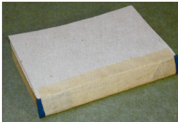
5. Katke selg korralikult PVA-liimi ja kangaga, mis on selja pikkusest natukene lühem, kuid külgedelt ulatuks umbes 1–2 cm üle. Seejärel liimige (tehke seda alles siis, kui esi- ja tagapaberid on kleebitud).
