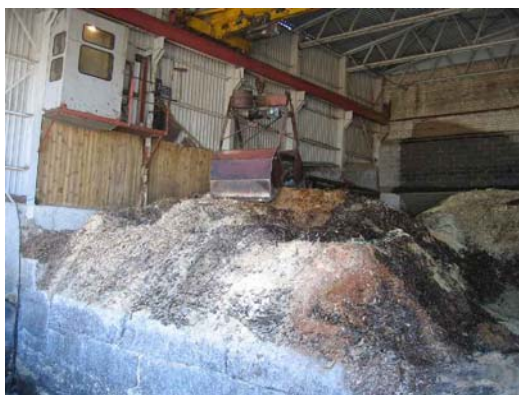
Рис. 8.32. Мостовой кран с грейфером (фото Ю. Каськ)
