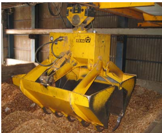
Рис. 5.4. Грейферный кран (фото Ю. Касък)
