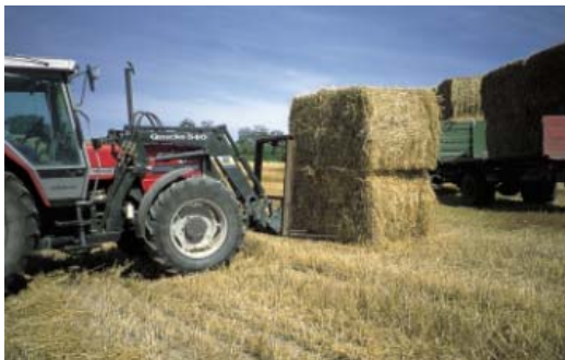
Рис. 3.62. Погрузка тюков смонтированным на тракторе фронтальным подъемником [50]
