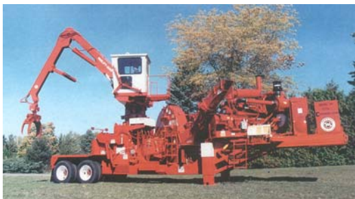
Рис. 3.43. Дисковый измельчитель Morbark 30 на трейлере [39]
