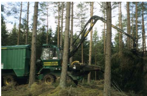
Рис. 3.11. Сбор и измельчение отходов рубки мобильным измельчителем Chipset 536С (фото П. Муйсте)
