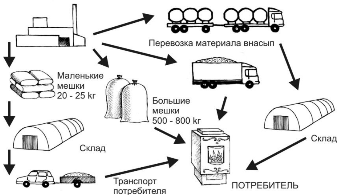
Рис. 3.59. Схема снабжения пеллетами
