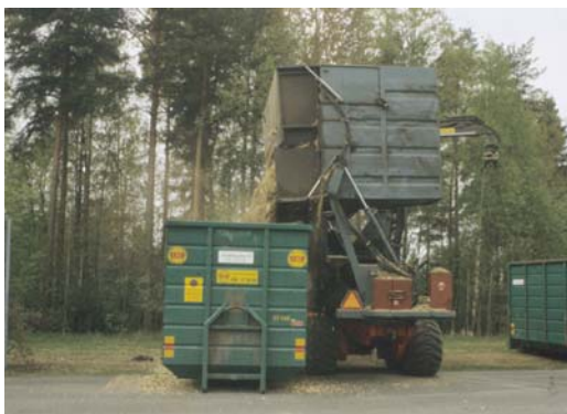
Рис. 3.12. Опорожнение контейнера мобильного измельчителя (фото П. Муйсте)
