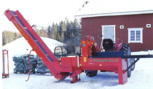
Рис. 3.51. Клинообразные колун с гидроприводом [45]
