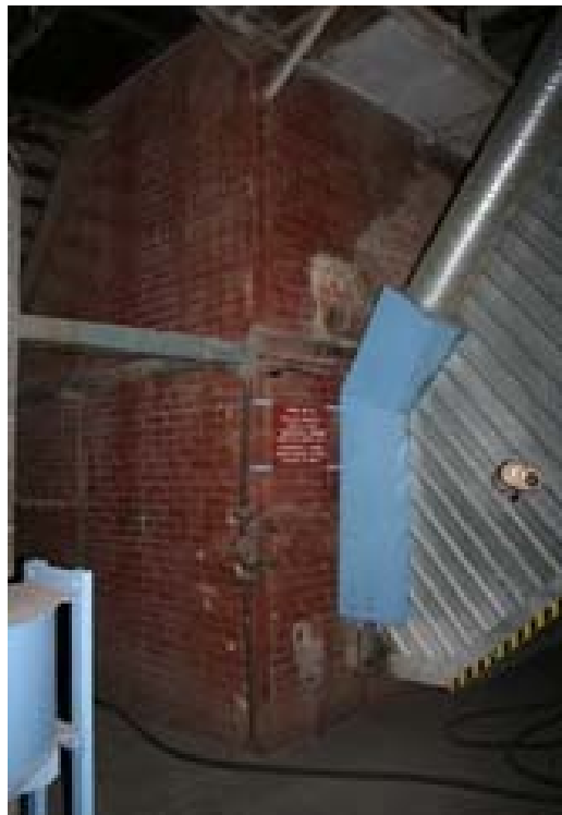
Рис. 8.17. Канал третичного воздуха (фото Ю. Каськ)
