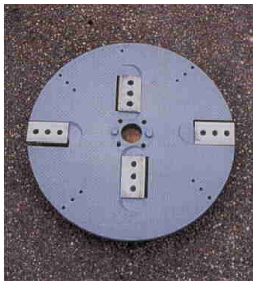
Рис. 3.27. Рабочий орган дискового измельчителя
