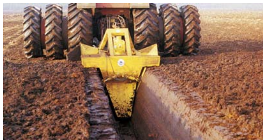
Рис. 3.65. Прессование осушающих канав в почве торфяника агрегатом OJ-1.3K финской фирмы Suokone OY
