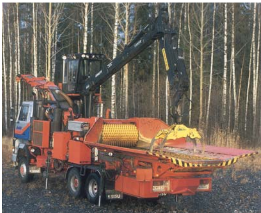
Рис. 3.41. На грузовике установлен измельчитель Giant [38]
