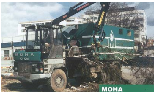
Рис. 3.42. Контейнеровоз с измельчителем MoHa [38]
