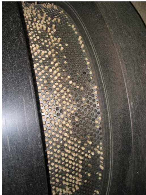
Рис. 3.58. Цилиндрическая матрица (фото П. Муйсте)
