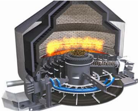
Рис. 4.6. Запатентованная Wärtsilä топка BioGrate с конусной решеткой и с нижней подачей топлива
