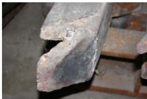
Рис. 8.15. Колосник с прогоревшим торцом (фото Ю. Касък)
