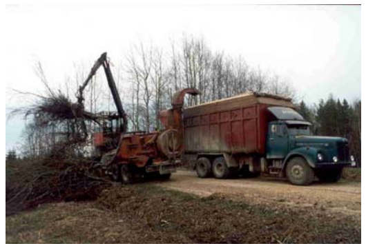
Рис. 3.19. Измельчение отходов рубки (фото П. Муйсте)
