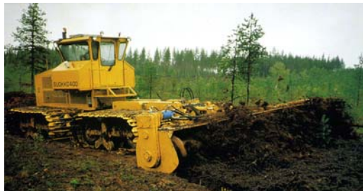
Рис. 3.64. Удаление растительности и выравнивание площадки агрегатом RT-6.0H финской фирмы Suokone OY
