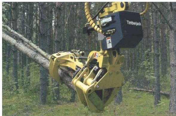
Рис. 3.53. Собирающие головки Timberjack 720 ja Timberjack 730 [41]
