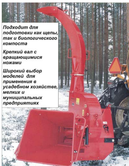
Рис. 3.34. Дисковый измельчитель Junkkari HJ 10 с приводом от сельхозтрактора [34]
