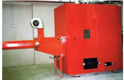
Рис. 4.20. Горелка для твердого топлива, разработанная в Таллинском техническом университете, с универсальным котлом мощностью 240 кВт
