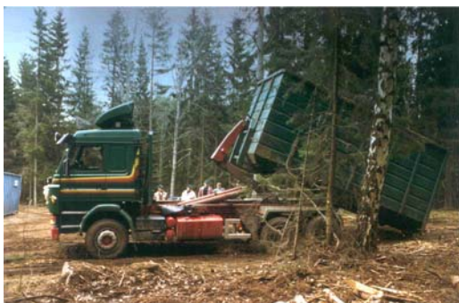
Рис. 3.13. Подъем полного контейнера на тягач (фото П. Муйсте)
