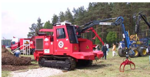
Рис. 3.40. Экскаватор как база измельчителя (фото П. Муйсте)
