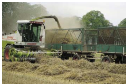
Рис. 3.60. Подбор соломы, измельчение и погрузка в транспорт [50]
