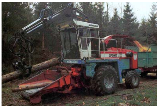
Рис. 3.39. Комбайн в качестве базовой машины [37]
