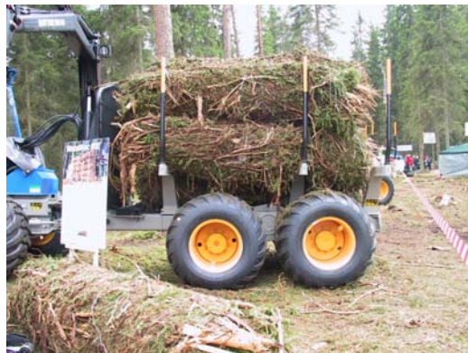
Рис. 3.48. Для перевозки вязанок можно использовать обычный лесозовный прицеп (фото П. Муйсте)
