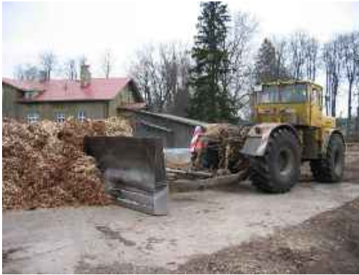
Рис. 8.31. Трактор для подачи топлива (фото Ю. Касък)
