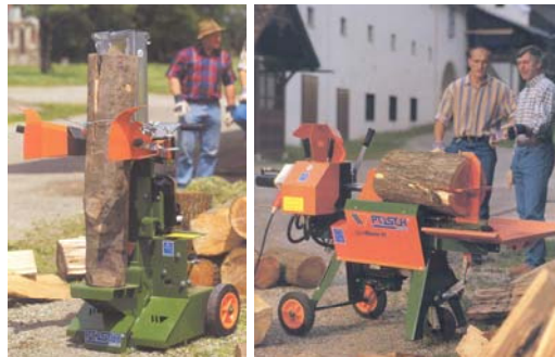
Рис. 3.51. Клинообразные колун с гидроприводом [45]
