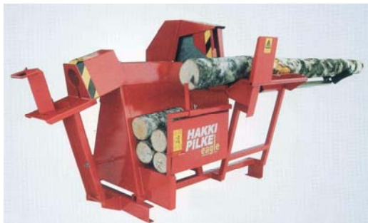
Рис. 3.50. Машина Hakke Pilke Eagle с коническим колун и дисковой пилой [44]
