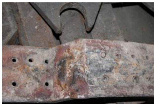
Рис. 8.14. Колосник, отработавший 1 год (фото Ю. Касък)
