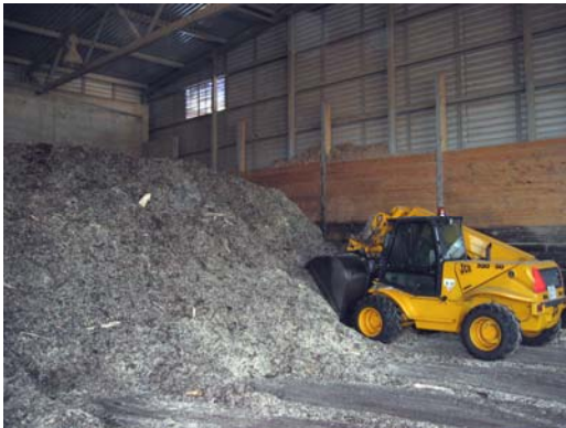
Рис. 5.3. Автопогрузчик с фронтальным ковшом (фото Ю. Касък)
