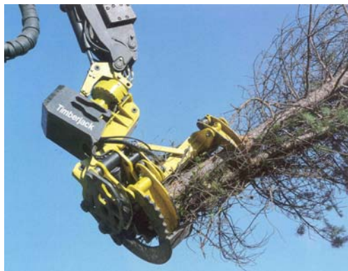
Рис. 3.53. Собирающие головки Timberjack 720 ja Timberjack 730 [41]
