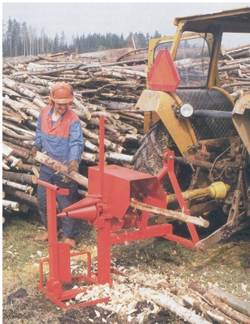
Рис. 3.49. Конусный колун объединенный с окоривателем [43]
