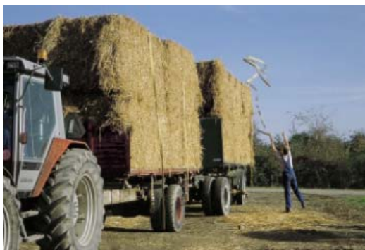
Рис. 3.63. Крепление тюков ремнями, необходимое для обеспечения устойчивости груза при перевозке [50]
