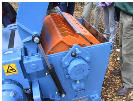
Рис. 3.29. Рабочий орган барабанного измельчителя (фото П. Муйсте)
