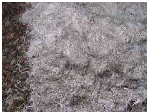
Рис. 8.11. Древесная щепа, измельченная молотковой дробилкой (фото Ю. Касък)
