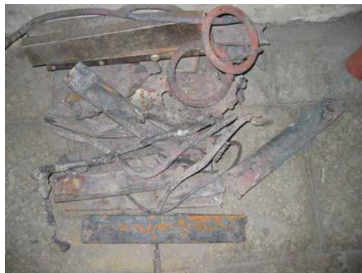
Рис. 8.25. Куски металла, обнаруженные в топливе и золе (фото Ю. Каськ)
