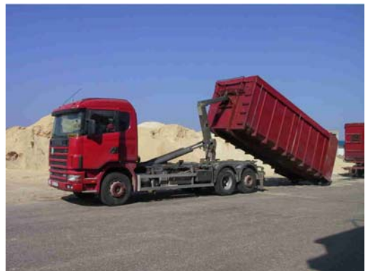
Рис. 3.20. Перевозка щепы контейнеровозом (фото П. Муйсте)
