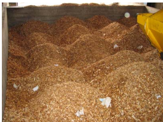
Рис. 8.10. Топливо равномерно распределяется автоматическим грейфером (фото Ю. Касък)
