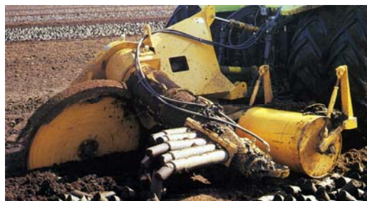
Рис. 3.66. Фрезирование массы торфа из торфяника и прессование кускового торфа агрегатом PK-1S финской фирмы Suokone OY
