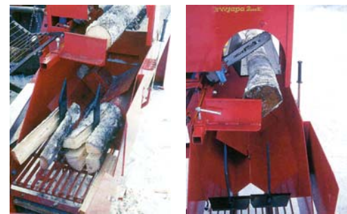
Рис. 3.52. Комбинированный колун Jara 2000 [46]
