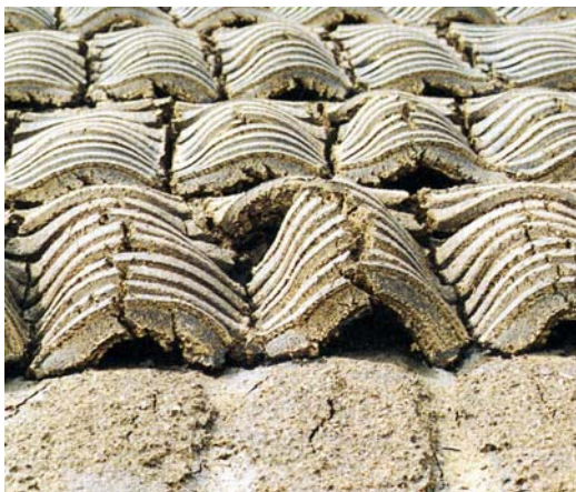
Рис. 3.67. Волнообразно прессованный кусковой торф, имеющий минимальный контакт с поверхностью болота и быстрее сохнущий
