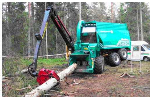
Рис. 3.36. Мобильный подборщик щепы, Silvatec 878 CH [35] (фото П. Муйсте)
