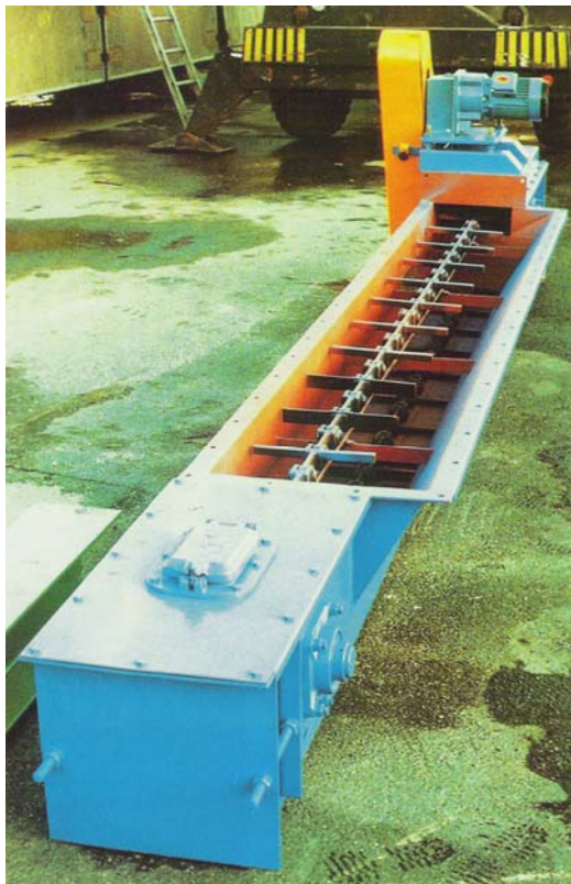
Рис. 6.6. Скребокый транспортер (Saxlund)
