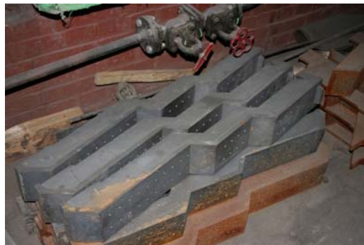
Рис. 8.13. Новые колосники, изготовленные на заводе в Тарту (фото Ю. Касък)
