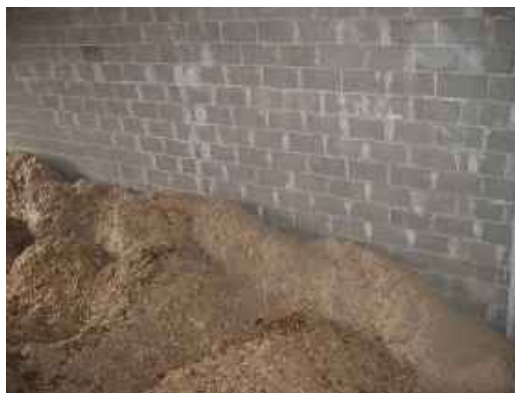
Рис. 8.39. Застой топлива вблизи стенок (фото Ю. Касък)
