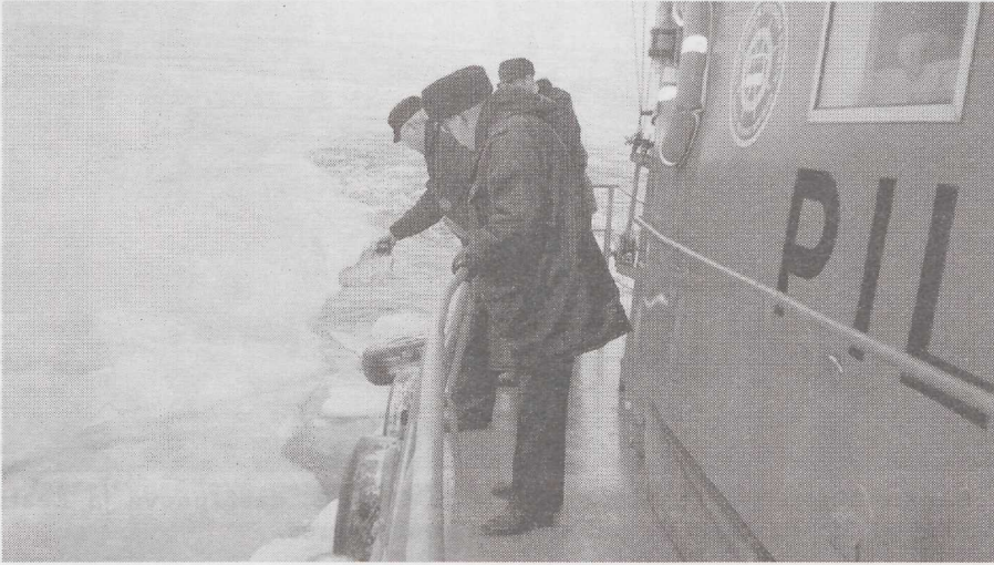
"Ahto-03" kapten Valentin Morozov mõõdab jää paksust.
