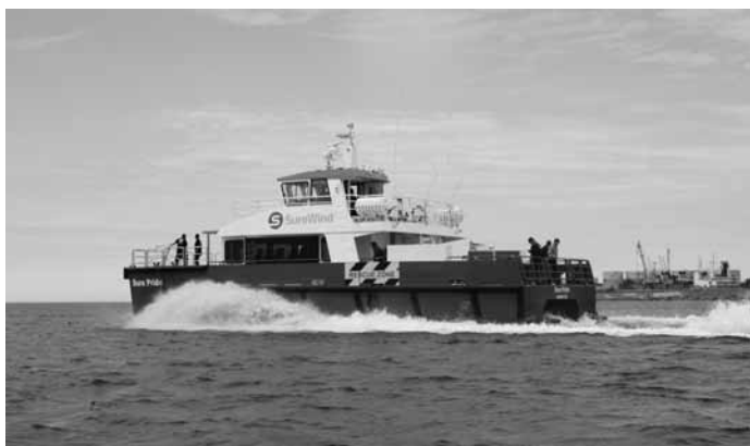
Esimese avamere tuuleparkide teenindamiseks mõeldud katamaraan, mille BLRT Grupi Eesti spetsialistid ehitasis tervenisti alumiiniumist ja andsid üle tellijale tänavu juulis.
