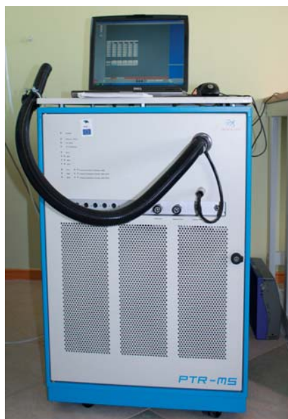
Foto 4. Prootonülekanereaktsiooni mass-spektromeeter PTR-MS
