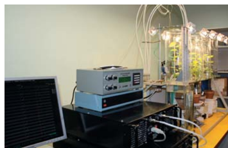
Foto 7. Isopreenanalüsaator mõotmas isopreeni emissiooni haabadest
