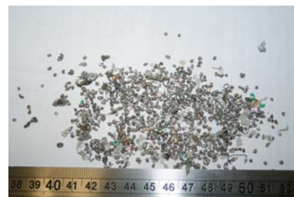
Joonis 8. Jämedast fraktsioonist (1,25–2,5 mm) eraldatud raudmetallid
