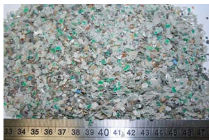
Joonis 7. Jämedast fraktsioonist (1,25–2,5 mm) eraldatud mittemagnetiline materjal – komposiitplastid ja mitteraudmetallid
