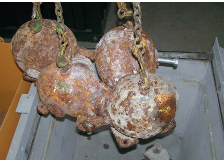
Joonis 1. Roostes kiirgusallikakonteinerid Foto: Ivo Tartik
