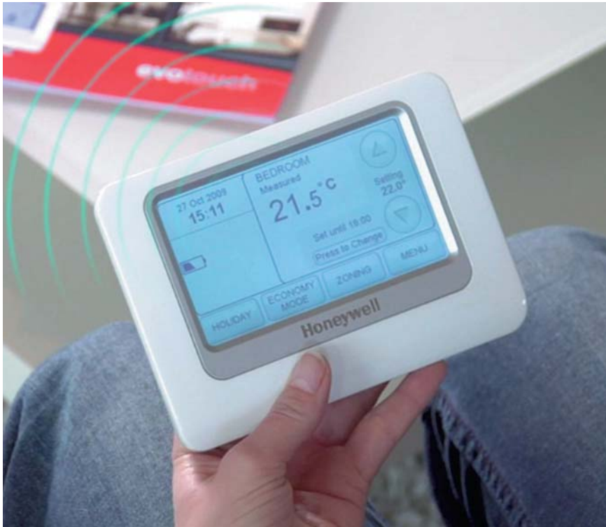
Puutetundliku LCD-ekraaniga koduautomaatikakontroller EvoTouch
