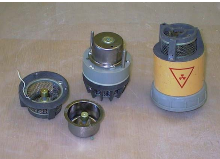
Joonis 4. Tuumamaterjali sisaldavad suitsuandurid
