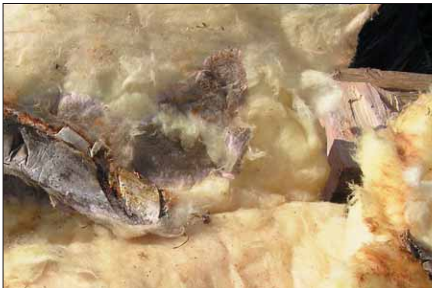
FOTO 9. TÜKIKE SEENENIIDISTIKUGA PÕIMUNUD MINERAALVILLA
