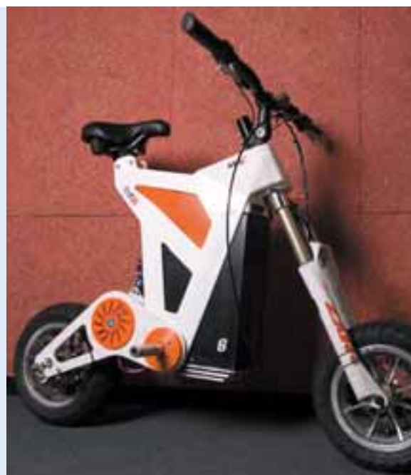
Üks Exo-Bike prototüüpidest, mis tõestas, et veorihm peab olema veidi tugevam.
